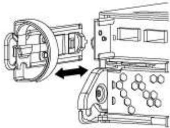
4. 按压凸轮把手上的闩锁，直到其释放为止，完全打开凸轮把手以从中板释放控制器模块，然后用两只手将控制器模块拉出机箱。
