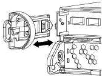
4. 如果您在拔下缆线后将 SFP 模块留在系统中，请将其移至新控制器模块。
