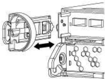
3. 按压凸轮把手上的闩锁，直到其释放为止，完全打开凸轮把手以从中板释放控制器模块，然后用两只手将控制器模块拉出机箱。
