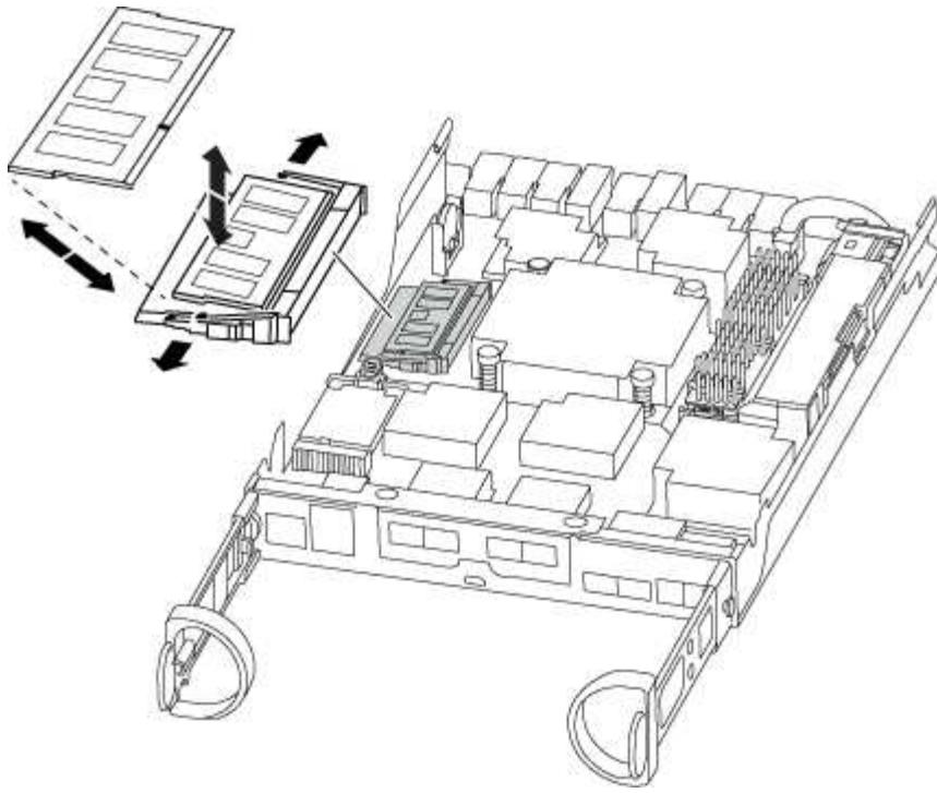
8. 从防静电运输袋中取出更换用的 DIMM，拿住 DIMM 的边角并将其与插槽对齐。
