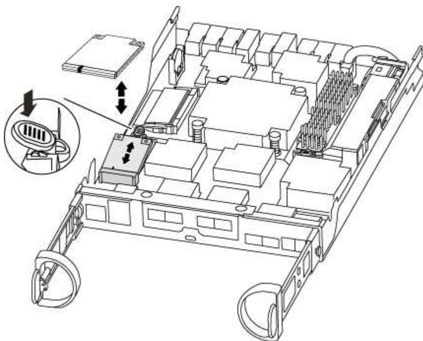
2. 按启动介质外壳上的蓝色按钮，将启动介质从其外壳中释放，然后将其竖直拉出启动介质插槽。
