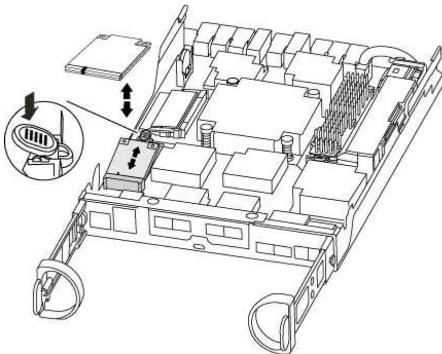
3. 按启动介质外壳上的蓝色按钮，将启动介质从其外壳中释放，然后将其竖直拉出启动介质插槽。
