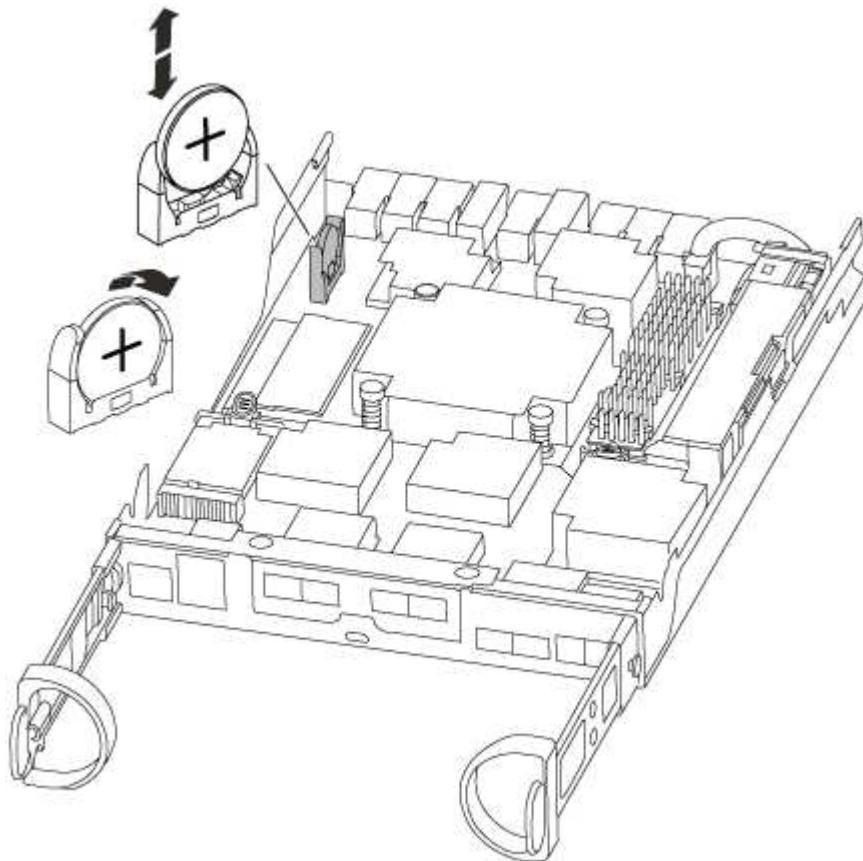
2. 将电池轻轻推离电池架，将其旋转出电池架，然后将其从电池架中取出。
