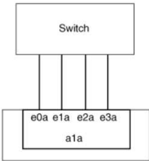
通过多种技术，可以在一个聚合链路中的流量分布在多个物理交换机上。用于实现此功能的技术因网络产品而异。ONTAP 中的静态多模式接口组符合 IEEE 802.3 标准。如果某种特定的多交换机链路聚合技术可与 IEEE 802.3 标准互操作或符合这些标准，则该技术应与 ONTAP 配合使用。
