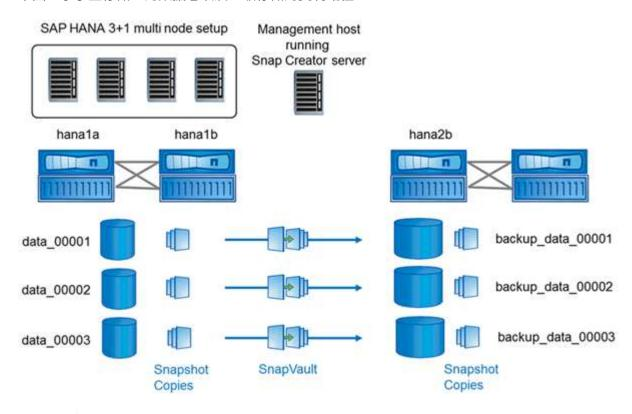
必须在二级存储控制器上创建需要备份的所有卷。在此示例中,在二级存储控制器上创建了卷 backup data 00001 , backup data 00002 和 backup data 00003 。
