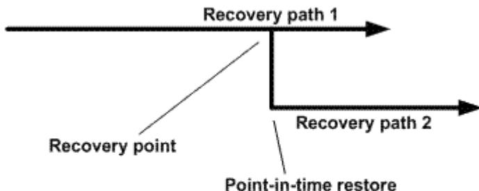
在该映像中，恢复路径 1 由一个完整备份和多个事务日志备份组成。将数据库还原到某个时间点。在时间点还原操作之后会创建新的事务日志备份，从而导致恢复路径 2。创建新的事务日志备份时，不会创建新的完整备份。由于数据损坏或其他问题，在创建新的完整备份之前，您无法还原当前数据库。此外，无法将在恢复路径 2 中创建的事务日志应用于属于恢复路径 1 的完整备份。
