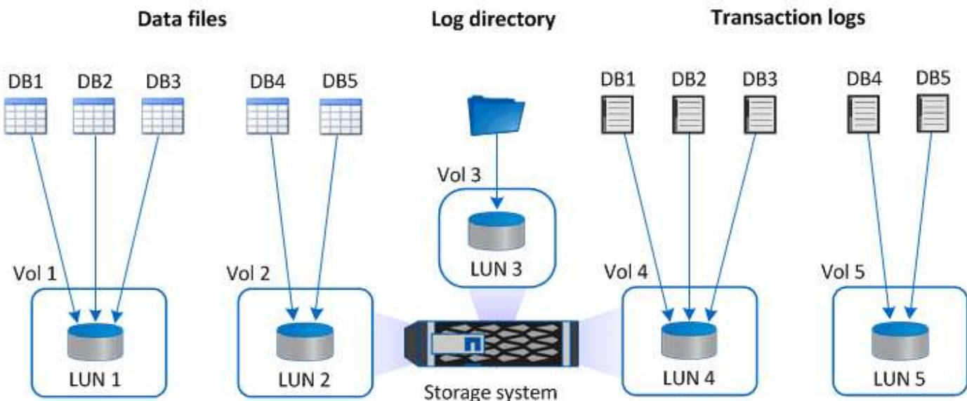
下图显示了如何为 VMDK 上的大型数据库配置存储布局：
