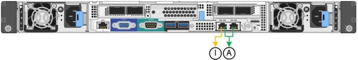
在独立模式下，只有左侧的管理端口连接到管理网络。此模式不提供冗余路径。右侧的管理端口未连接，可用于临时本地连接（使用 IP 地址 169.254.0.1）
