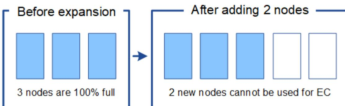
要解析此问题描述 并使用新的存储节点，您可以运行 EC 重新平衡操作步骤。运行此操作步骤时，StorageGRID 会在站点的所有存储节点之间重新分发经过纠删编码的数据和奇偶校验片段。在此示例中，当 EC 重新平衡操作步骤 完成后，所有五个节点的容量现在仅为 60%，并且可以继续将对象载入所有存储节点上的 2+1 纠删编码方案。
