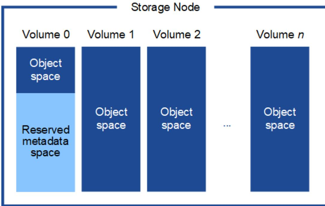
如图所示，StorageGRID 会为每个存储节点的存储卷 0 上的对象元数据预留空间。它会使用预留空间存储对象元数据并执行基本数据库操作。存储卷 0 和存储节点中所有其他存储卷上的任何剩余空间仅用于对象数据（复制的副本和经过纠删编码的片段）。
