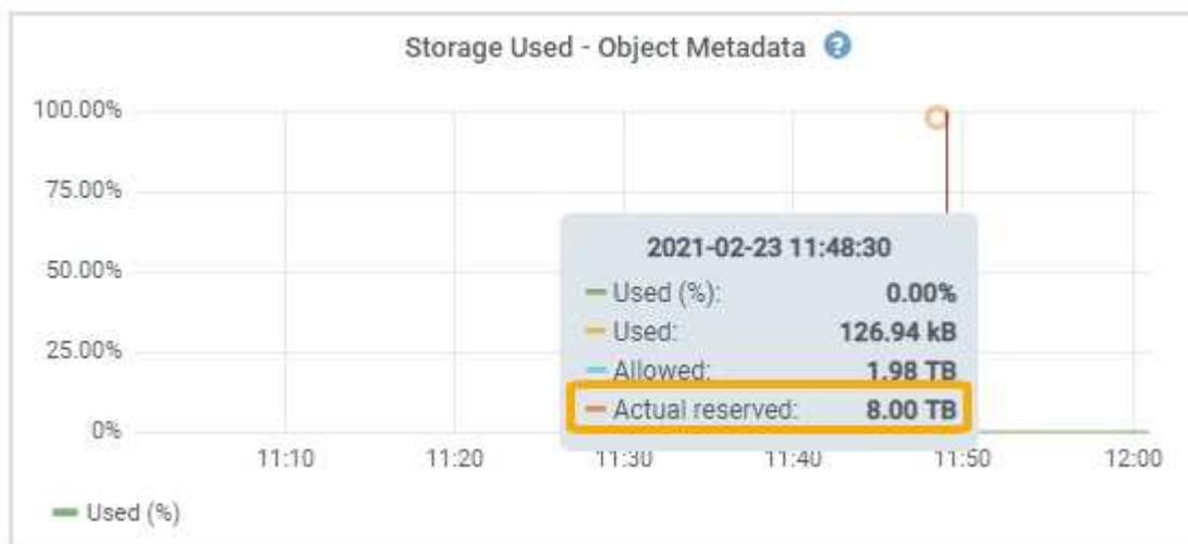
在屏幕截图中，\* 实际预留 \* 值为 8 TB 。此屏幕截图适用于新安装的StorageGRID 11.5中的大型存储节点。由于此存储节点的系统范围元数据预留空间设置小于卷 0 ，因此此节点的实际预留空间等于元数据预留空间设置。
