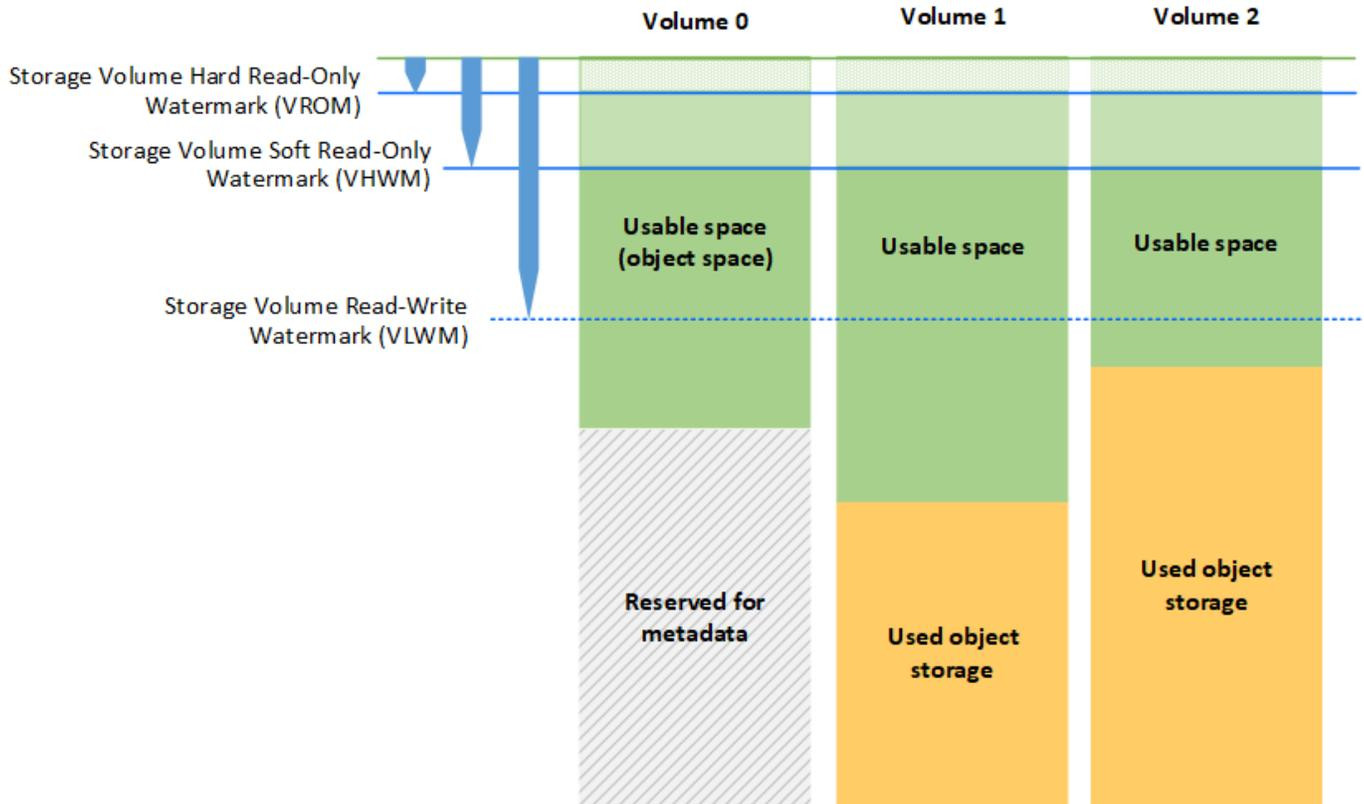
存储卷水印是系统范围的默认设置、表示存储节点中每个卷所需的最小可用空间量、以防止StorageGRID 更改节点的读写行为或触发警报。请注意、在StorageGRID 执行操作之前、所有卷都必须达到水印。如果某些卷的可用空间量超过所需的最小可用空间量、则不会触发警报、并且节点的读写行为也不会发生变化。
