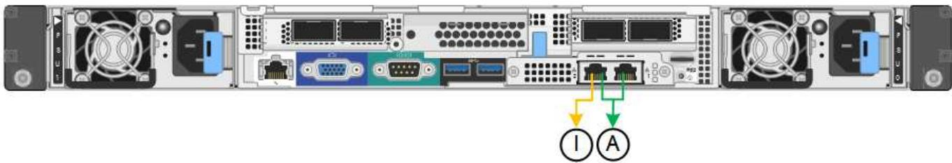
在独立模式下，只有左侧的管理端口连接到管理网络。此模式不提供冗余路径。右侧的管理端口未连接，可用于临时本地连接（使用 IP 地址 169.254.0.1）
