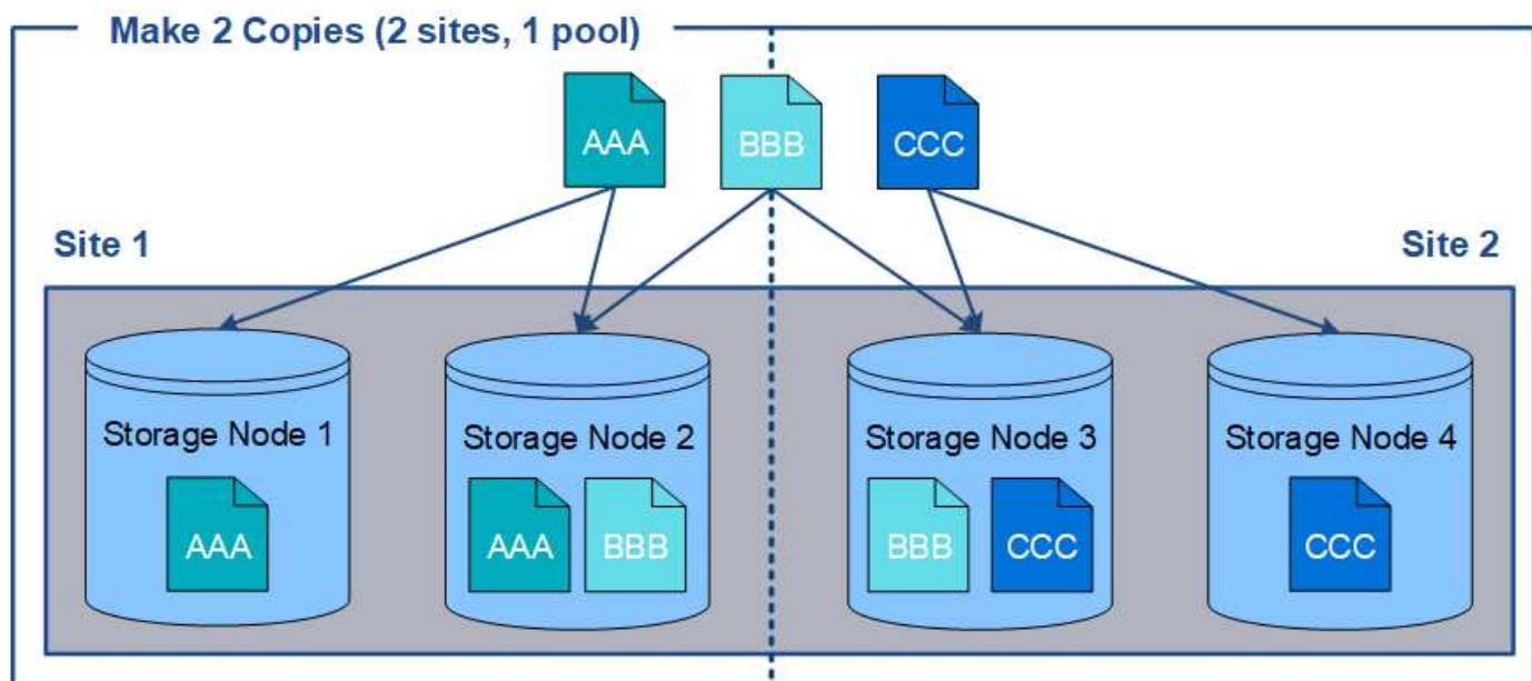
相比之下，此示例说明了使用多个存储池时对象的存储方式。在此示例中，ILM 规则指定为每个对象创建两个副本，并将这些副本分发到两个存储池。每个存储池都包含一个站点上的所有存储节点。由于每个对象的副本存储在每个站点上，因此，可以防止对象数据出现站点故障或无法访问。
