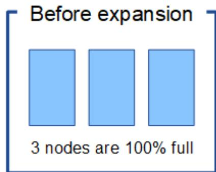
要在此示例中扩展站点，建议您添加三个或更多新的存储节点。StorageGRID 需要三个存储节点来执行 2+1 纠删编码，以便可以将两个数据片段和一个奇偶校验片段放置在不同的节点上。
