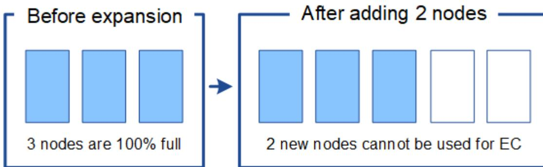
要解析此问题描述 并使用新的存储节点，您可以运行 EC 重新平衡操作步骤。运行此操作步骤 时，StorageGRID 会在站点的所有存储节点之间重新分发经过纠删编码的数据和奇偶校验片段。在此示例中，当 EC 重新平衡操作步骤 完成后，所有五个节点的容量现在仅为 60%，并且可以继续将对象载入所有存储节点上的 2+1 纠删编码方案。
