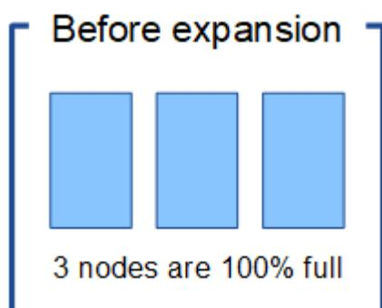
要在此示例中扩展站点，建议您添加三个或更多新的存储节点。StorageGRID 需要三个存储节点来执行 2+1 纠删编码，以便可以将两个数据片段和一个奇偶校验片段放置在不同的节点上。
