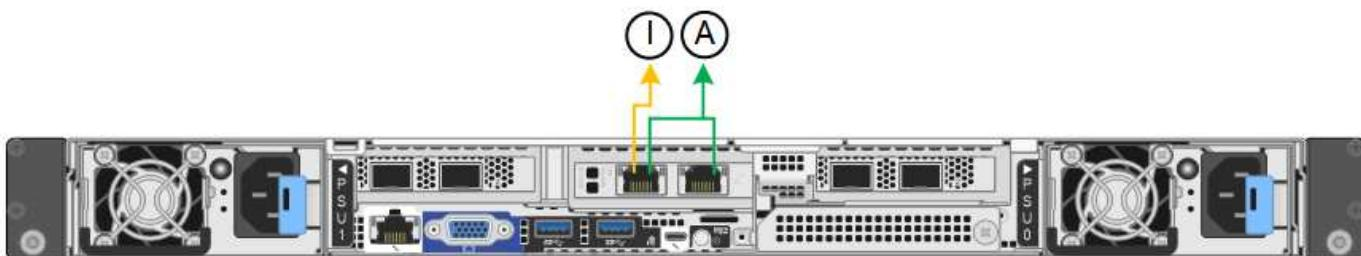
在独立模式下，只有左侧的管理端口连接到管理网络。此模式不提供冗余路径。右侧的管理端口未连接、可用于临时本地连接(使用IP地址169.254..1)。
