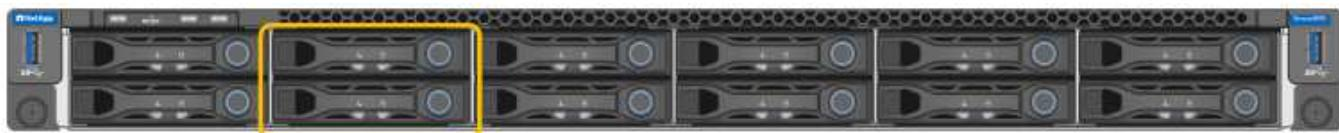
橙色轮廓线表示的两个固态驱动器(SSD)用于存储StorageGRID 操作系统、并使用RAID 1进行镜像以实现冗余。将 SG100 或 SG1000 服务设备配置为管理节点时，这些驱动器用于存储审核日志，指标和数据库表。
