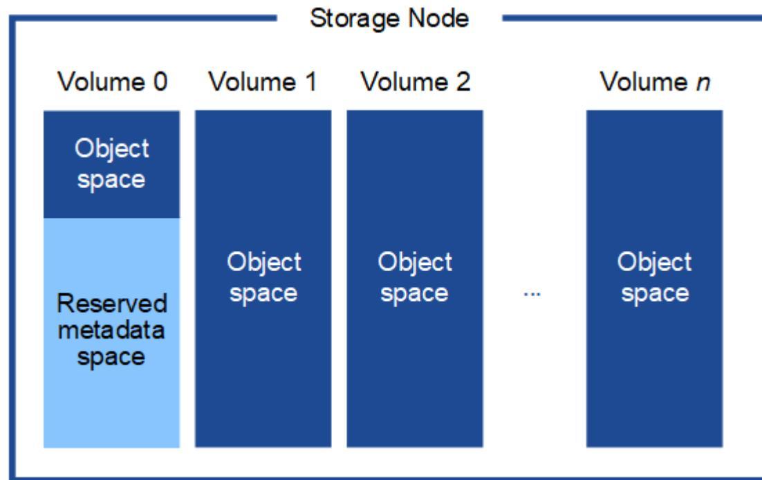
如图所示，StorageGRID 会为每个存储节点的存储卷 0 上的对象元数据预留空间。它会使用预留空间存储对象元数据并执行基本数据库操作。存储卷 0 和存储节点中所有其他存储卷上的任何剩余空间仅用于对象数据（复
