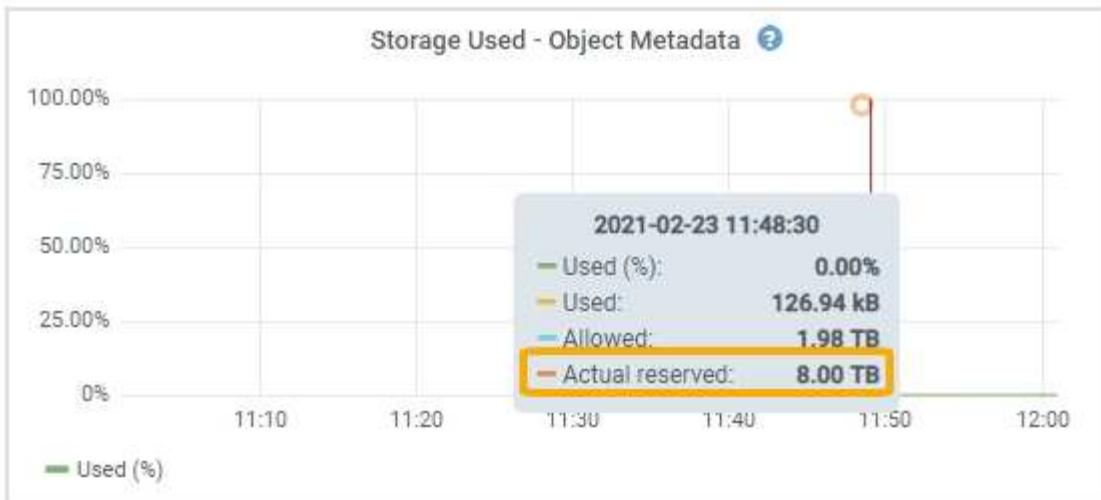
在屏幕截图中，\* 实际预留 \* 值为 8 TB。此屏幕截图适用于新 StorageGRID 11.6 安装中的大型存储节点。由于此存储节点的系统范围元数据预留空间设置小于卷 0，因此此节点的实际预留空间等于元数据预留空间设置。
