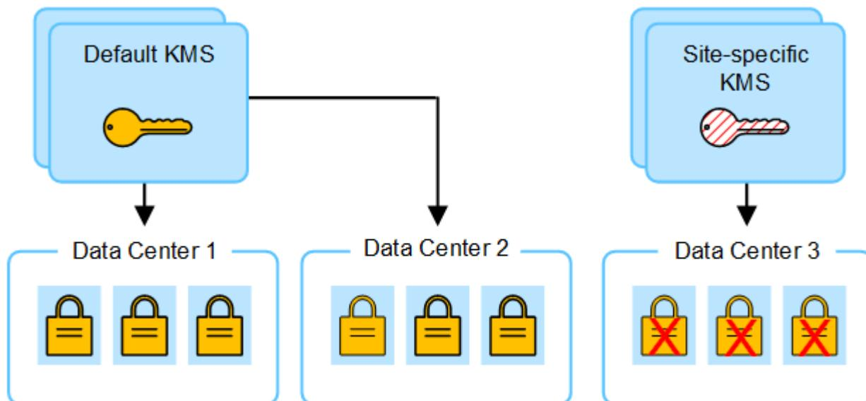
4. 要解决问题描述 问题，请将当前版本的加密密钥从默认 KMS 复制到新的 KMS。（从技术上讲，您可以将原始密钥复制到具有相同别名的新密钥。原始密钥将成为新密钥的先前版本。）现在，站点特定的 KMS 具有用于对数据中心 3 上的设备节点进行解密的正确密钥，因此可以将其保存在 StorageGRID 中。
