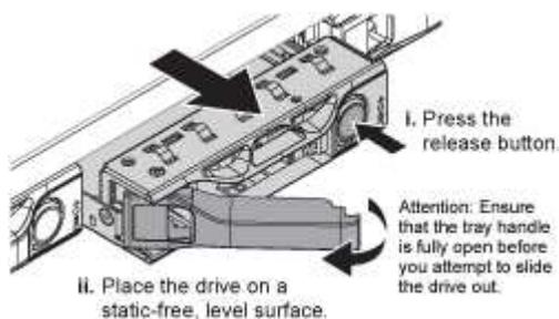
驱动器弹出器上的手柄部分打开，驱动器从插槽中释放。
