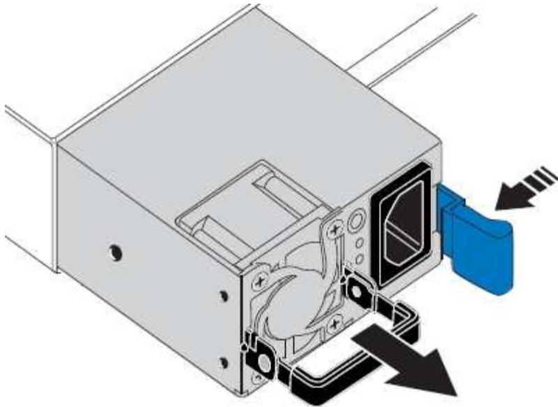
5. 使蓝色门锁位于右侧，将替代电源滑入机箱。
