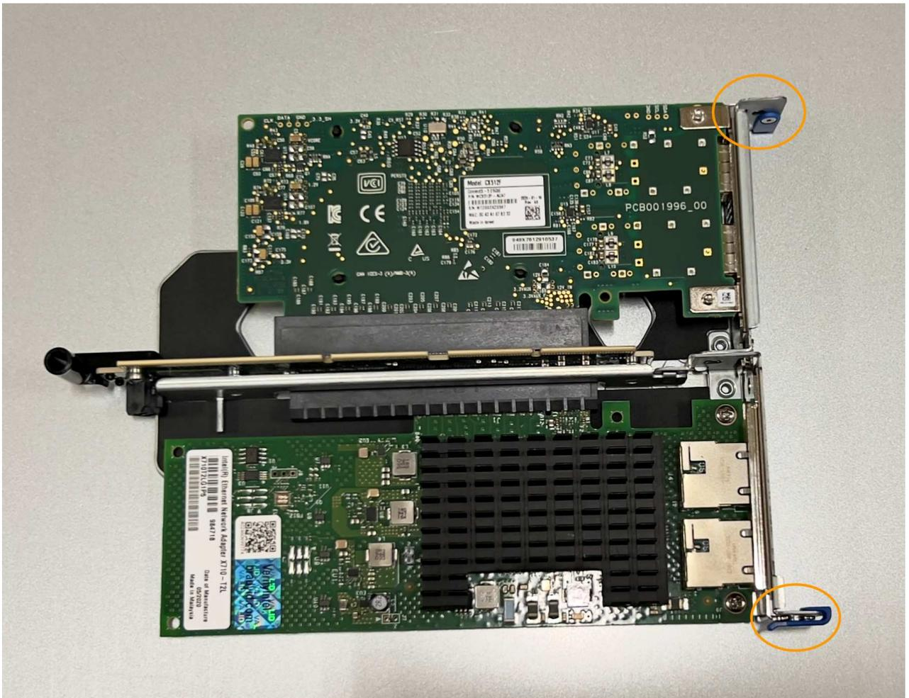
c. 找到与系统板上的导销对齐的双插槽提升板部件上的定位孔(圈出)、以确保提升板部件正确定位。
