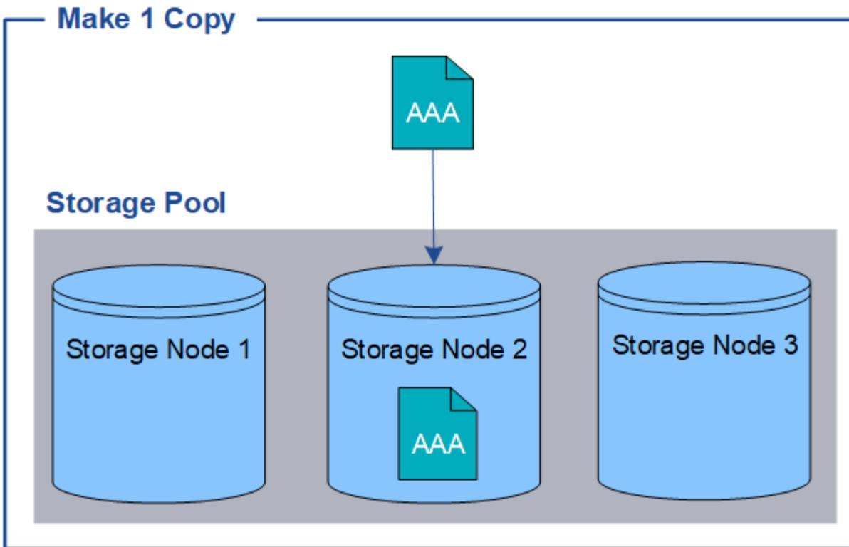
如果 ILM 规则仅创建一个对象的一个复制副本，则在存储节点不可用时，此对象将无法访问。在此示例中，只要存储节点 2 脱机，例如在升级或其他维护操作步骤 期间，您将暂时无法访问对象 AAA。如果存储节点 2 发生故障，您将完全丢失对象 AAA。
