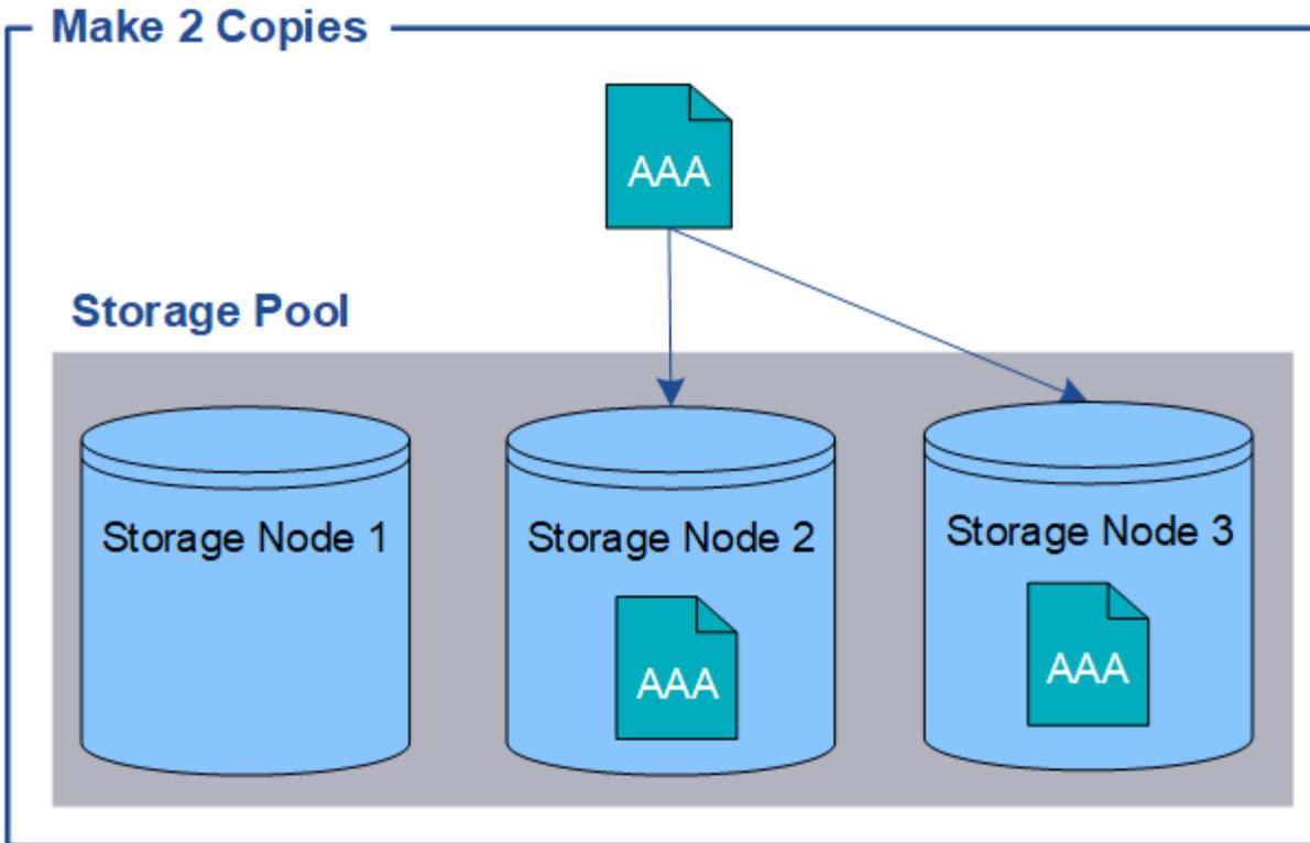
当 StorageGRID 将对象与此规则匹配时，它会为该对象创建两个副本，并将每个副本放置在存储池中的不同存储节点上。这两个副本可以放置在三个可用存储节点中的任意两个上。在这种情况下，规则会将对象副本放置在存储节点 2 和 3 上。由于有两个副本，因此，如果存储池中的任何节点出现故障，可以检索此对象。
