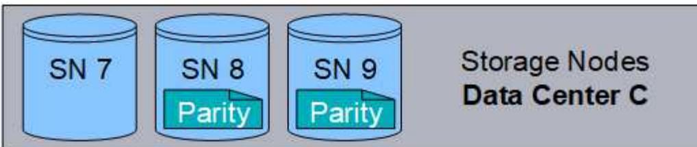
如果丢失两个以上的存储节点，则无法检索此对象。
