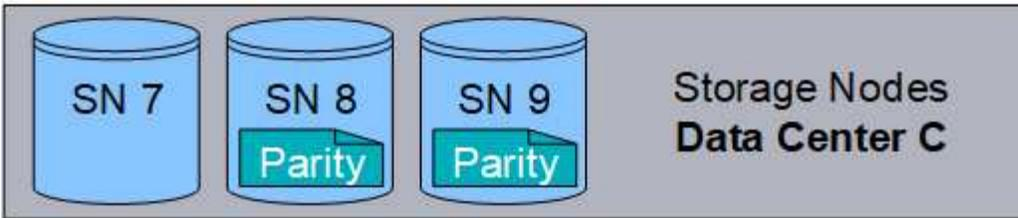
4+2纠删编码方案可以通过多种方式进行配置。例如，您可以配置一个包含六个存储节点的单站点存储池。适用于“站点丢失保护”，则可以使用包含三个站点的存储池，每个站点上有三个存储节点。只要六个片段中的任意四个（数据或奇偶校验）仍然可用，就可以检索对象。最多可以丢失两个片段，而不会丢失对象数据。如果整个站点丢失、只要所有其他碎片仍可访问、就可以检索或修复对象。
