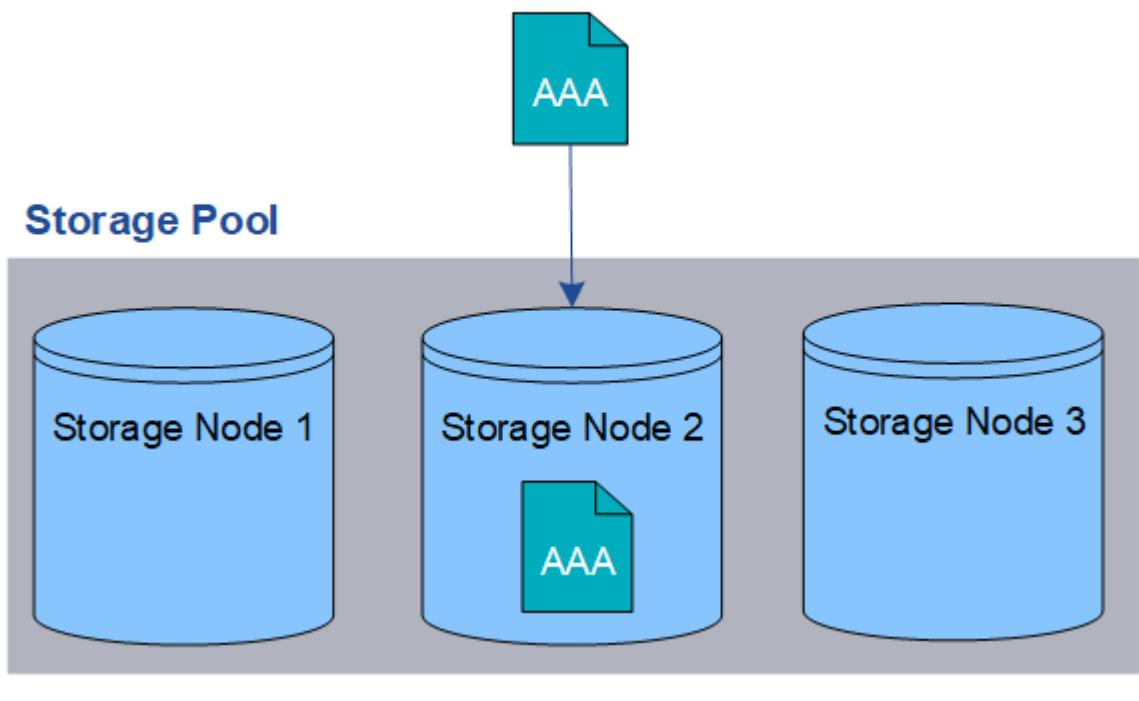
如果 ILM 规则仅创建一个对象的一个复制副本，则在存储节点不可用时，此对象将无法访问。在此示例中，只要存储节点 2 脱机，例如在升级或其他维护操作步骤期间，您将暂时无法访问对象 AAA。如果存储节点 2 发生故障，您将完全丢失对象 AAA。
