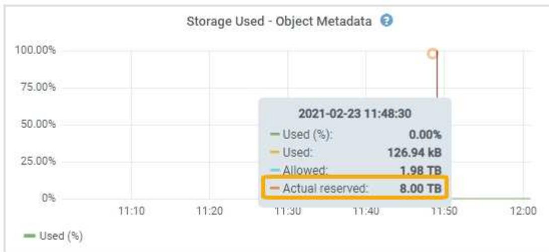
在屏幕截图中，\* 实际预留 \* 值为 8 TB。此屏幕截图适用于新 StorageGRID 11.6 安装中的大型存储节点。由于此存储节点的系统级元数据预留空间设置小于卷0、因此此节点的实际预留空间等于元数据预留空间设置。
