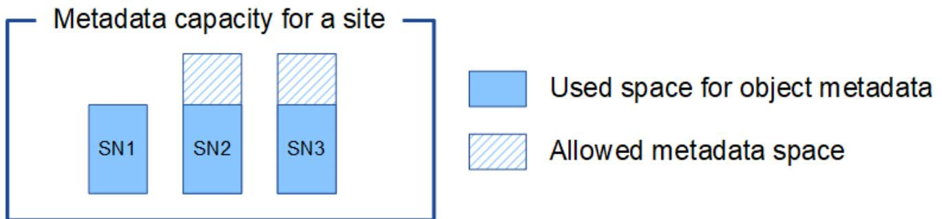
同样，由于 StorageGRID 会维护每个站点上 StorageGRID 系统的所有对象元数据，因此 StorageGRID 系统的整体元数据容量取决于最小站点的对象元数据容量。
