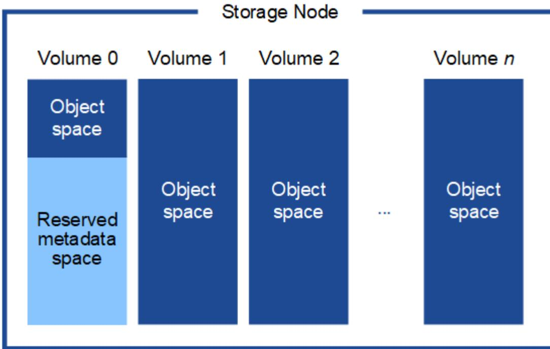
为了提供冗余并防止对象元数据丢失，StorageGRID 会为每个站点的系统中的所有对象存储三个元数据副本。对象元数据的三个副本均匀分布在每个站点的所有存储节点上。
