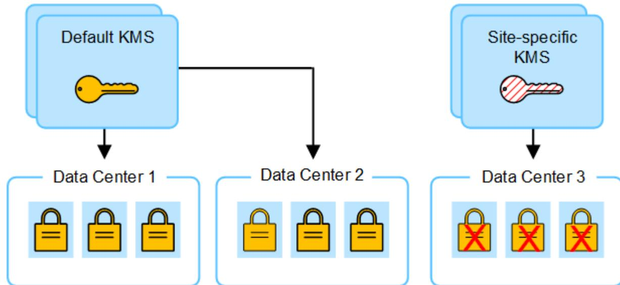
4. 要解决问题描述 问题，请将当前版本的加密密钥从默认 KMS 复制到新的 KMS。（从技术上讲，您可以将原始密钥复制到具有相同别名的新密钥。原始密钥将成为新密钥的先前版本。）现在，站点特定的 KMS 具有用于对数据中心 3 上的设备节点进行解密的正确密钥，因此可以将其保存在 StorageGRID 中。
