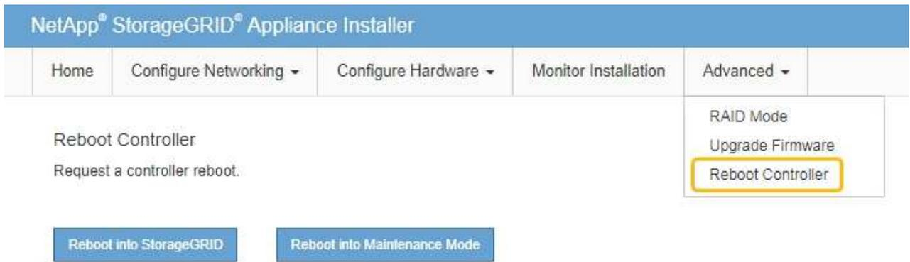
设备重新启动并重新加入网格可能需要长达 20 分钟的时间。要确认重新启动已完成且节点已重新加入网格，请返回网格管理器。节点页面应显示正常状态(绿色复选标记图标)
