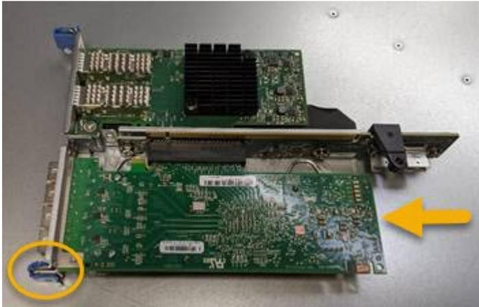
提升板部件中有两个适配器：一个光纤通道 HBA 和一个以太网网络适配器。图中显示了光纤通道 HBA。
