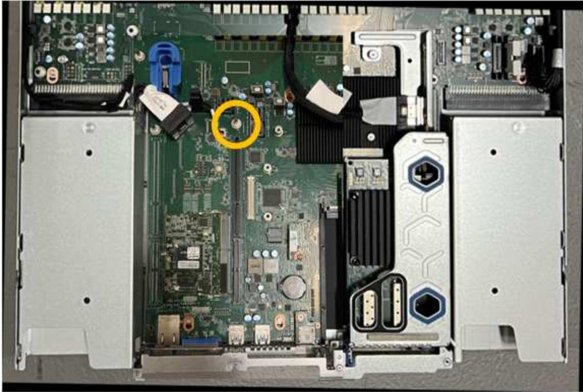
6. 将提升板部件置于机箱中、确保其与系统板上的连接器和导销对齐。
