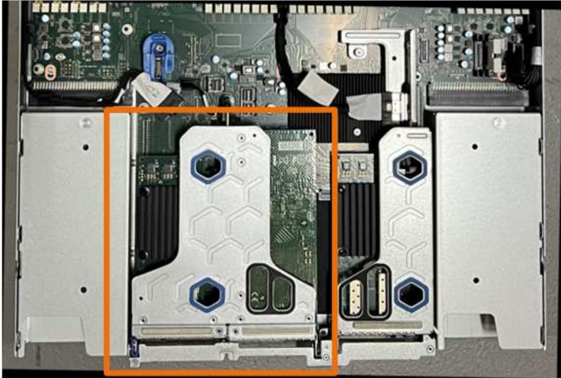
3. 抓住竖板部件并穿过蓝色标记的孔，然后小心地将其向上提起。提起提升板部件时，将其朝机箱正面移动，以使其安装的NIC中的外部连接器能够脱离机箱。
