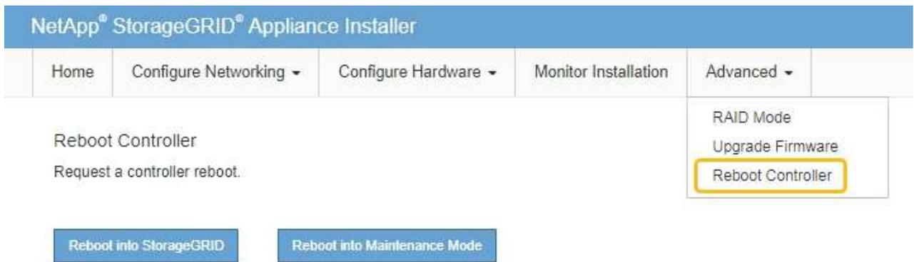
设备重新启动并重新加入网格可能需要长达 20 分钟的时间。要确认重新启动已完成且节点已重新加入网格，请返回网格管理器。n 节点\* 页面应显示正常状态(绿色复选标记图标
