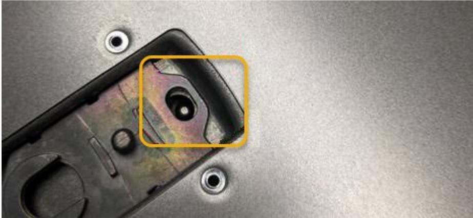
2. 向前和向下旋转机箱盖门锁，直到其停止，并且机箱盖完全就位到机箱中。确认外盖前边缘没有间隙。
