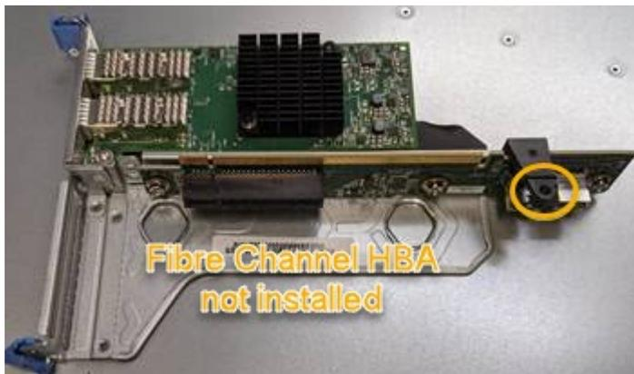
5. 将提升板部件置于机箱中，确保其与系统板上的连接器和导销对齐；然后，插入提升板部件。
