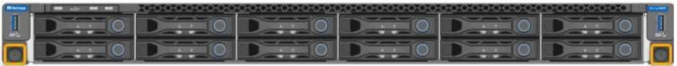
5. 将 SG110 或 SG1100 向前滑出机架、直至安装导轨完全展开、并且您可以听到两侧的门锁卡嗒声。
