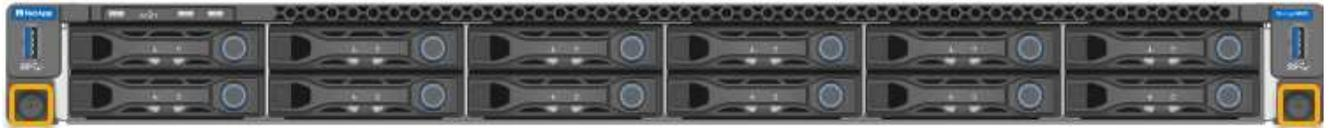
5. 将SGF6112向前滑出机架、直至安装导轨完全展开、并且您可以听到两侧的闩锁卡嗒声。
