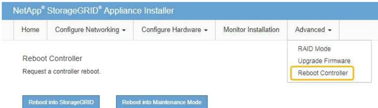
设备重新启动并重新加入网络可能需要长达 20 分钟的时间。要确认重新启动已完成且节点已重新加入网络，请返回网络管理器。n 节点\* 页面应显示正常状态(绿色复选标记图标
