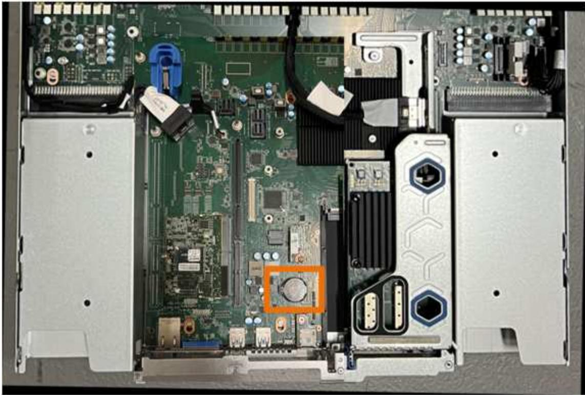
6. 使用手指或塑料撬起工具将固定夹(突出显示)从电池上按离、以将其从插槽中弹簧弹出。
