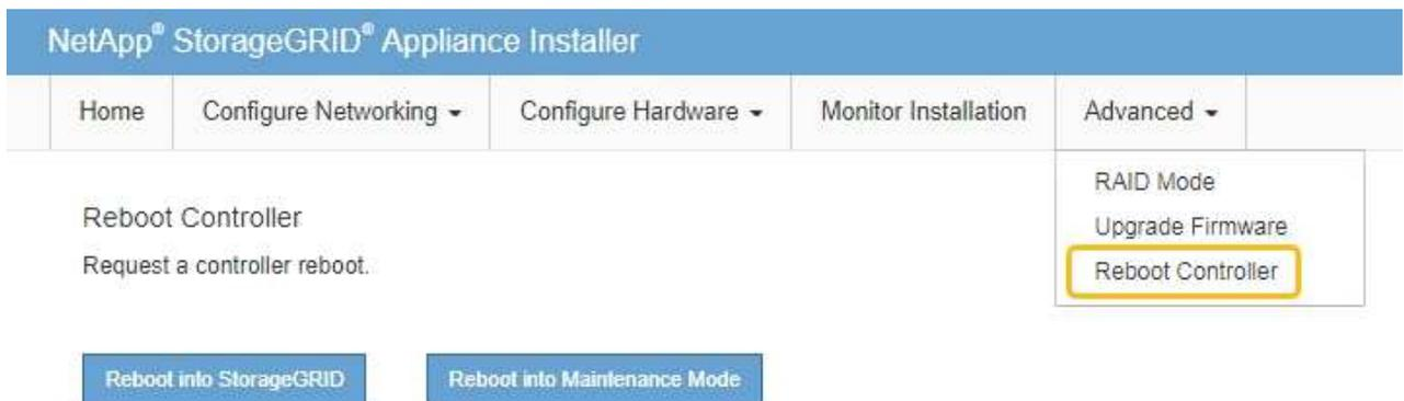
设备重新启动并重新加入网格可能需要长达 20 分钟的时间。要确认重新启动已完成且节点已重新加入网格，请返回网格管理器。n节点\*页面应显示正常状态(绿色复选标记图标 节点名称左侧)、表示没有
