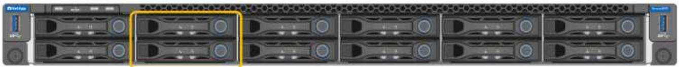
橙色轮廓线表示的两个固态硬盘(SSD)用于存储StorageGRID 操作系统、并使用RAID 1进行镜像以实现冗余。将SG100或SG1000服务设备配置为管理节点后、这些驱动器可能会用于存储审核日志、指标和数据库表。
