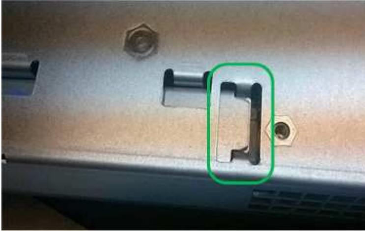
◦ \* 不正确 - 电池的金属法兰未插入控制器上的插槽： \*
