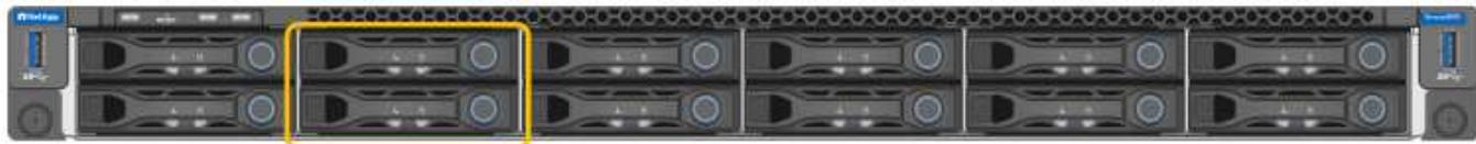
橙色轮廓线表示的两个固态驱动器(SSD)用于存储StorageGRID 操作系统、并使用RAID 1进行镜像以实现冗余。将SG100或SG1000服务设备配置为管理节点后、这些驱动器可能会用于存储审核日志、指标和数据库表。
