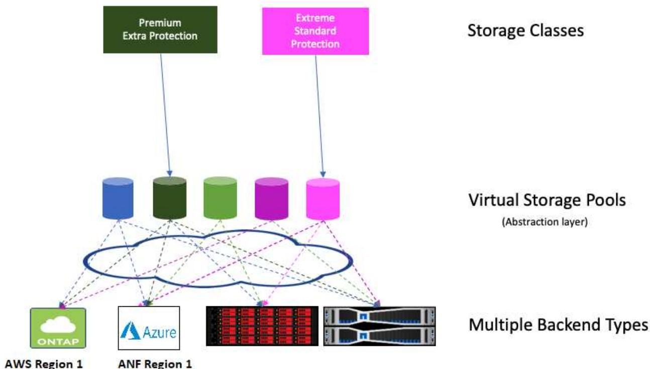
在虚拟池列表之外指定的任何方面对于后端都是全局的，并将应用于所有虚拟池，而每个虚拟池可能会分别指定一个或多个方面（覆盖任何后端 - 全局方面）。
