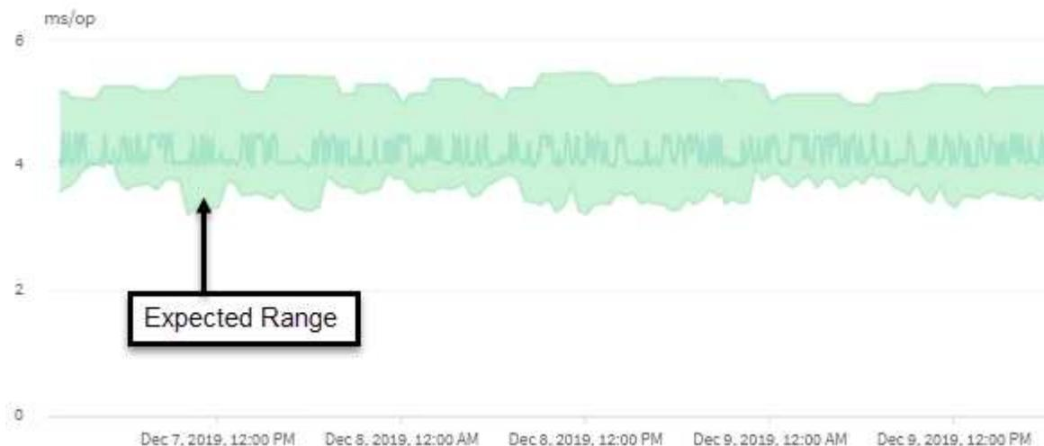
在此範例中、磁碟區的延遲預測以灰色顯示、每次作業延遲為3.5毫秒（毫秒/秒）、最低為5.5毫秒/秒（最高）。如果實際延遲（藍色）突然增加至10毫秒/次、因為網路流量間歇性激增或叢集元件發生爭用、則會超過延遲預測、並超過動態效能臨界值。
