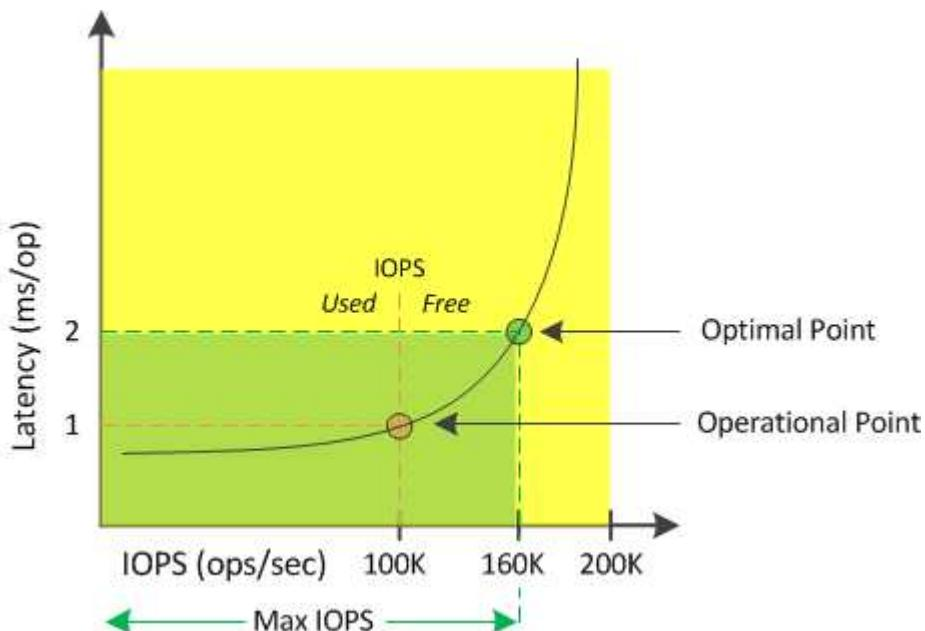
資源可提供的最大IOPS數是當使用效能容量計數器達到100%（最佳點）時的IOPS數目。作業點可識別節點目前以100K IOPS運作、延遲為1.0毫秒/作業根據從節點擷取的統計資料、Unified Manager會判斷節點的IOPS上限為160K、這表示可用或可用的IOPS為60K。因此、您可以將更多工作負載新增至此節點、以便更有效率地使用系統。
