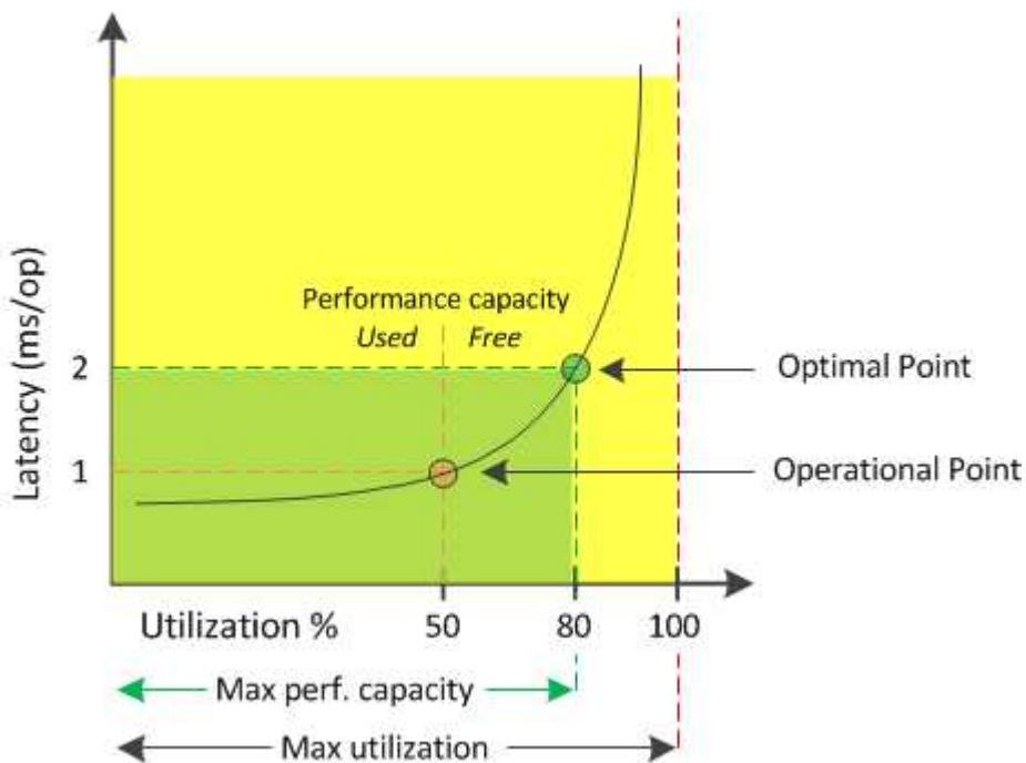
在此範例中、\_operoperate point\_可識別出集合體目前以50%的使用率運作、延遲為1.0毫秒/作業時間根據從Aggregate擷取的統計資料、Unified Manager會判斷此Aggregate是否有額外的效能容量可用。在此範例中、當Aggregate使用率達到80%、延遲為2.0毫秒/作業時、即會識別為最佳點因此、您可以將更多磁碟區和LUN新增至此集合體、以便更有效率地使用您的系統。
