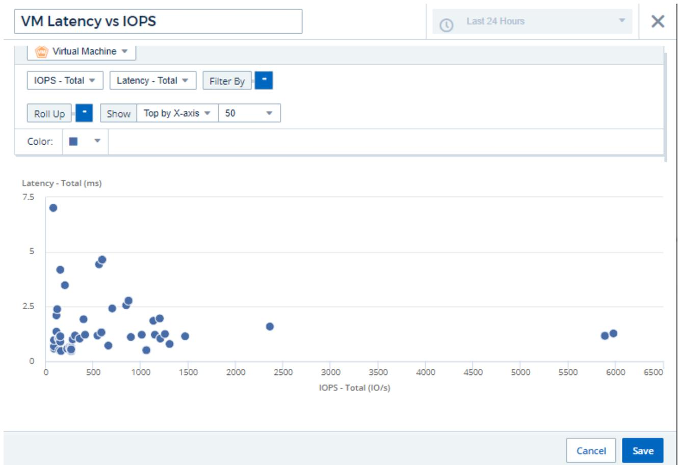
您可以選擇圖表以X軸顯示前N名、Y軸顯示前N名、X軸顯示下N名、Y軸顯示下N名。在最後一個範例中、圖表顯示前100名總IOPS最高的虛擬機器。如果我們將其變更為\*依Y軸\*上方、則圖表會再次顯示總延遲最高的前100個VM。
