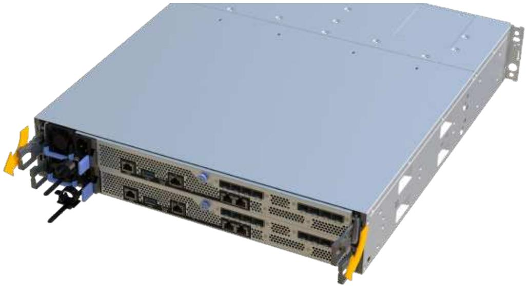
5. 確認控制器背面的快取作用中LED已關閉。
