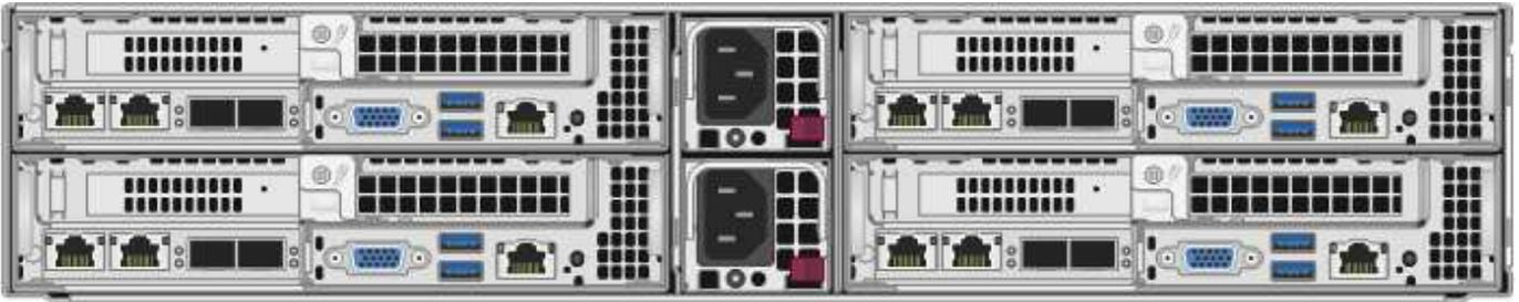
這是配備 H410S 節點的四節點機箱的正面視圖，圖中顯示了與每個節點對應的插槽：
