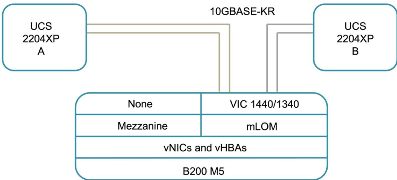
UCS 5108機箱與用於驗證的UCS 6454 FIs之間的連線能力、是由使用四個10G連線的IOM 2204XP所提供。這些連線的FI連接埠1到4均設定為伺服器連接埠。將FI連接埠25至28設定為網路上行鏈路連接埠、連接至本機站台的Nexus交換器A和B。下圖與表格提供UCS 6454 FIs連接UCS 5108機箱與Nexus交換器的連線圖與連接埠連線詳細資料。
