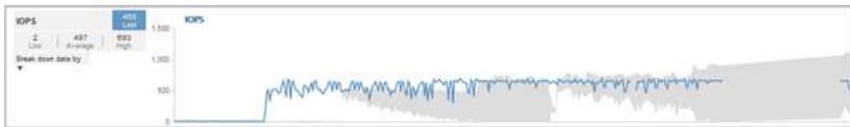
此範例顯示「效能/磁碟區詳細資料」頁面上的IOPS圖表。實際作業統計資料為藍色線、預期作業統計資料範圍為灰色。
