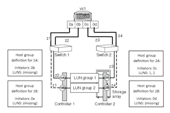
以下範例顯示 storage array config show ONTAP 系統已分區至儲存陣列、但儲存控制器 1A 的主機群組定義中沒有 LUN 的輸出、導致目標連接埠開放。控制器 1B 和 2B 在各自的主機群組定義中沒有 LUN 、因此會產生一個空的主機群組。
