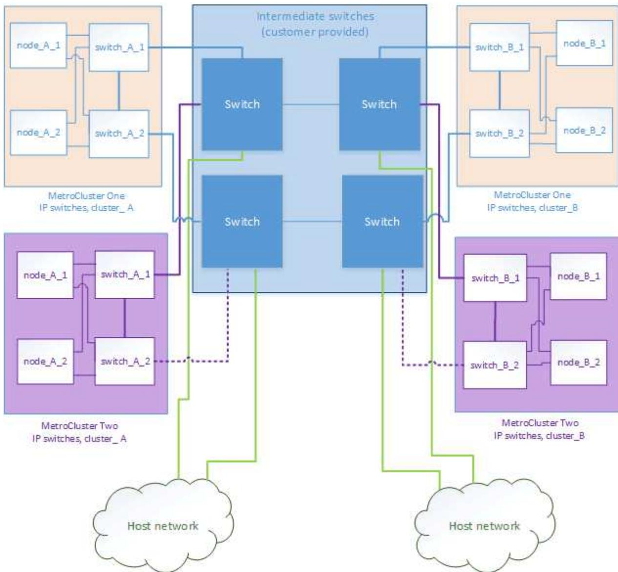
結合使用 NetApp 驗證交換器的 MetroCluster 組態、以及使用 MetroCluster 相容交換器的組態
