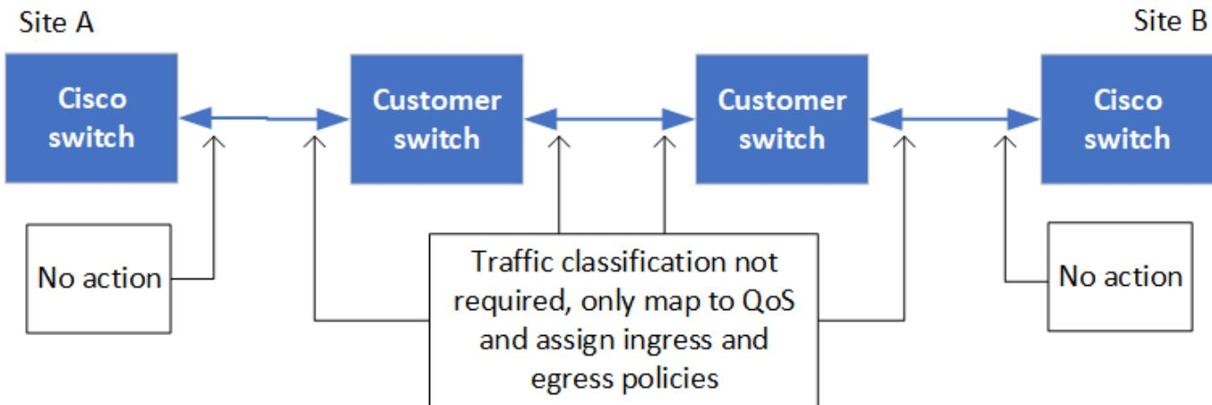
下圖概述當外部交換器為 Broadcom IP 交換器時、共用網路所需的設定。
