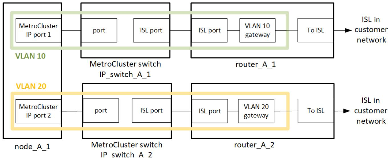
如所述、將此環境設定為標準的靜態IP組態、並以纜線連接MetroCluster MetroCluster ["設定MetroCluster 靜態硬體元件"](#)。執行安裝和佈線程序時、您必須執行第 3 層組態的特定步驟。以下內容適用於第 3 層組態：
