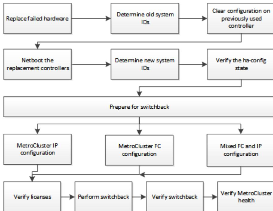
當發生故障時、可在進行中階轉換的系統上執行恢復時、使用此程序。在這種情況下、您必須在準備切換時執行適當的步驟、如程序所述。
