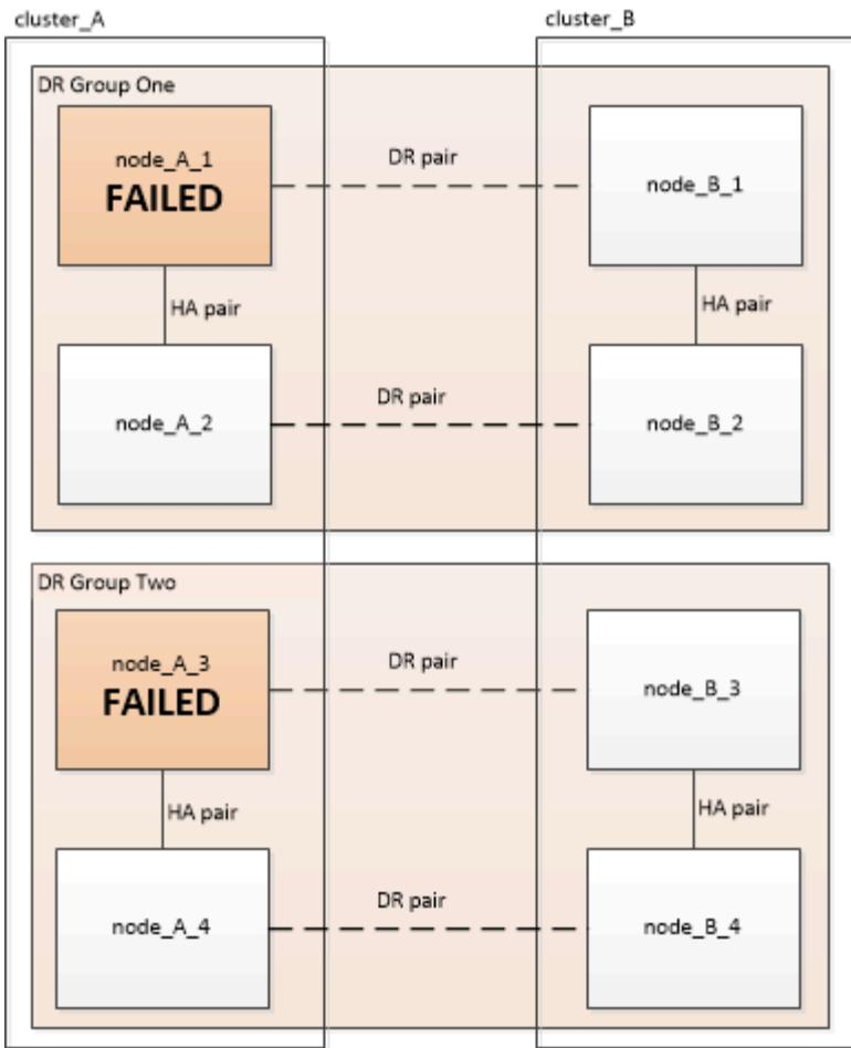
三個控制器模組故障分散在整個**DR**群組中
