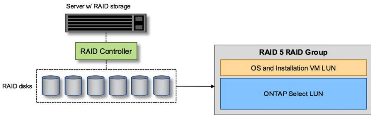
將OS LUN從ONTAP Select 同一個RAID群組配置為「支援」、可讓Hypervisor OS（以及任何也從該儲存設備配置的用戶端VM）受益於RAID保護。此組態可防止單一磁碟機故障導致整個系統關機。
