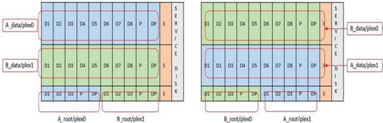
支援下列RAID類型的軟件RAID：RAID 4、RAID-DP及ONTAP RAID-TEC這些都是FAS 由Same和AFF Same平台所使用的相同RAID架構。root資源配置ONTAP Select 僅支援RAID 4和RAID-DP。使用RAID-TEC 資料Aggregate時、整體保護是RAID-DP。NetApp HA使用無共享架構、將每個節點的組態複寫到另一個節點。ONTAP Select這表示每個節點都必須儲存其根分割區及其對等根分割區的複本。由於資料磁碟有單一分割區、因此根據ONTAP Select 該節點是否屬於HA配對的一部分、資料磁碟的最小數量會有所不同。
