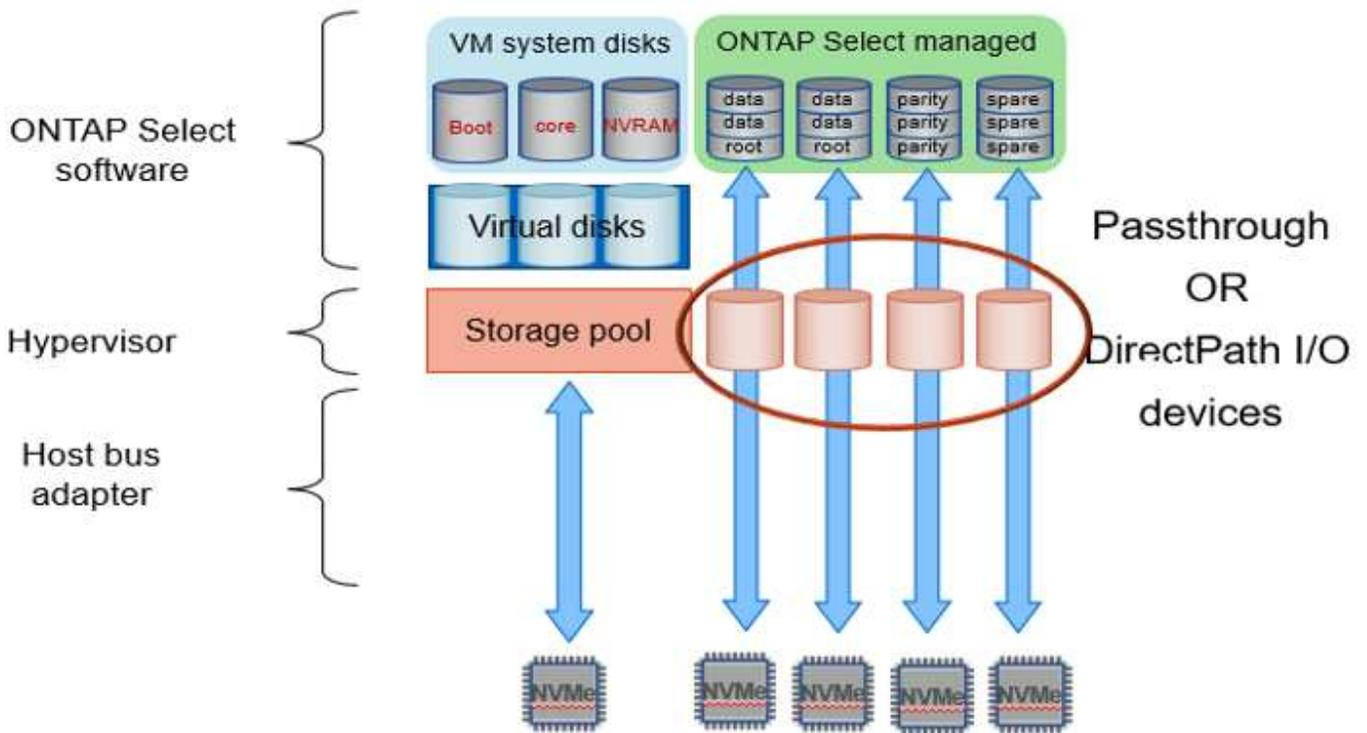
系統磁碟（VMDK）位於同一個資料存放區和同一個實體磁碟上。虛擬NVRAM磁碟需要快速且持久的媒體。因此、僅支援NVMe和SSD類型的資料存放區。在使用NVMe磁碟機進行資料時、基於效能考量、系統磁碟也應該是NVMe裝置。在All NVMe組態中、最適合使用系統磁碟的是Intel Optane卡。
