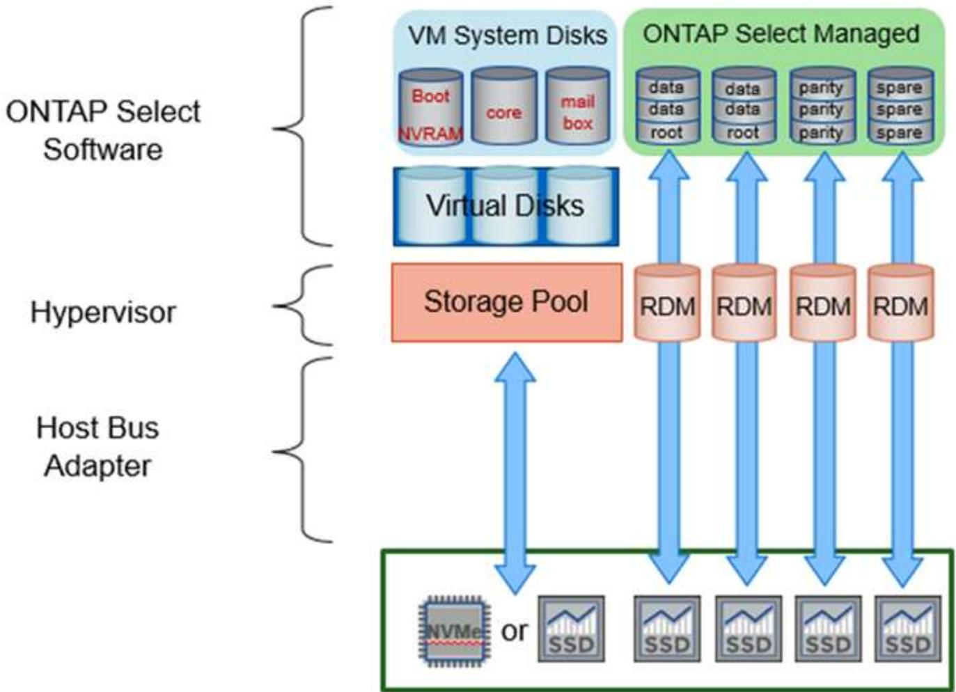
系統磁碟（VMDK）位於同一個資料存放區和同一個實體磁碟上。虛擬NVRAM磁碟需要快速且持久的媒體。因此、僅支援NVMe和SSD類型的資料存放區。
