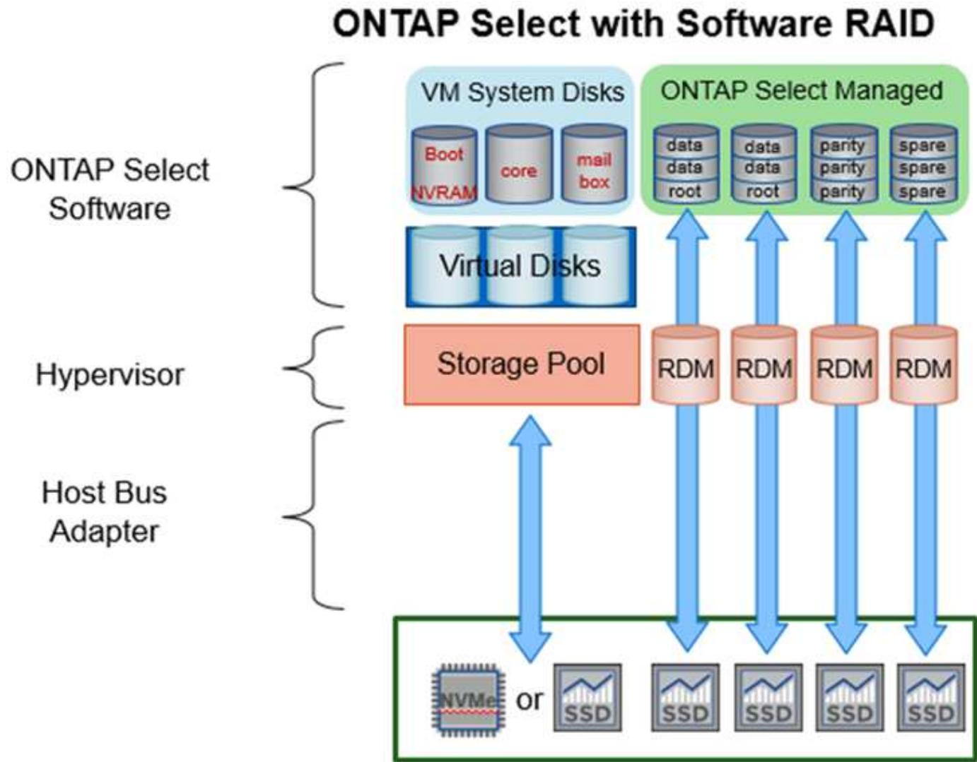
系統磁碟（VMDK）位於同一個資料存放區和同一個實體磁碟上。虛擬NVRAM磁碟需要快速且持久的媒體。因此、僅支援NVMe和SSD類型的資料存放區。
