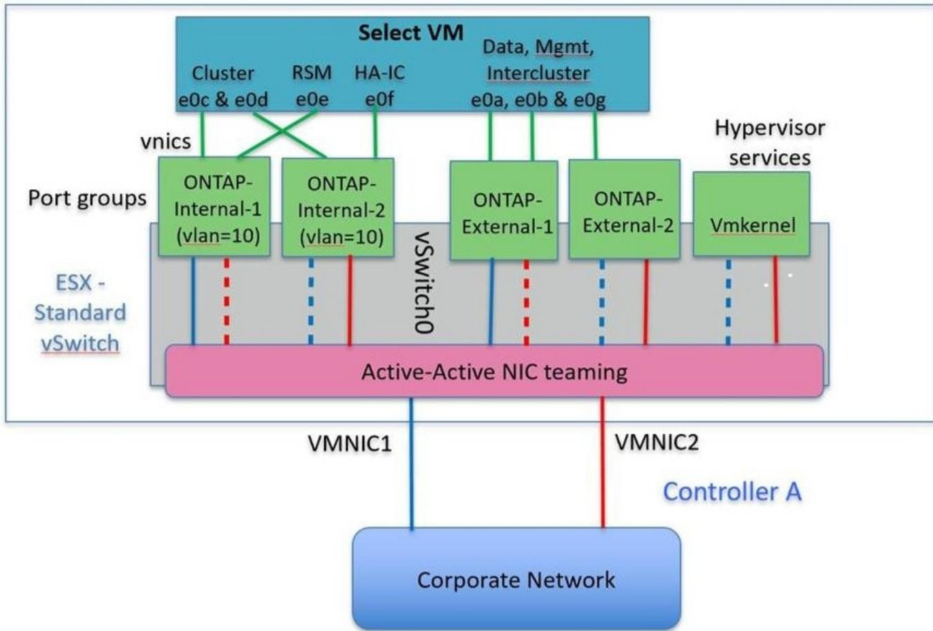
使用兩個實體連接埠（10Gb或更少）時、每個連接埠群組都應該有一個作用中的介面卡和一個彼此相對設定的待命介面卡。內部網路僅適用於多節點ONTAP Select 的叢集。對於單節點叢集、兩個介面卡都可在外部連接埠群組中設定為作用中。
