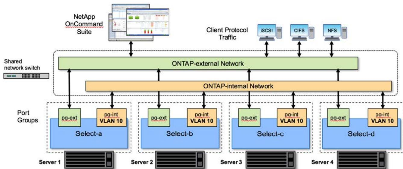
每ONTAP Select 個虛擬機器包含七個虛擬網路介面卡、以ONTAP 七個網路連接埠 (e0a到e0g) 的形式呈現給整個系統。雖然此類介面卡被視為實體NIC、但實際上它們是虛擬的、並透過虛擬化的網路層對應到一組實體介面。ONTAP因此、每個託管伺服器不需要六個實體網路連接埠。
