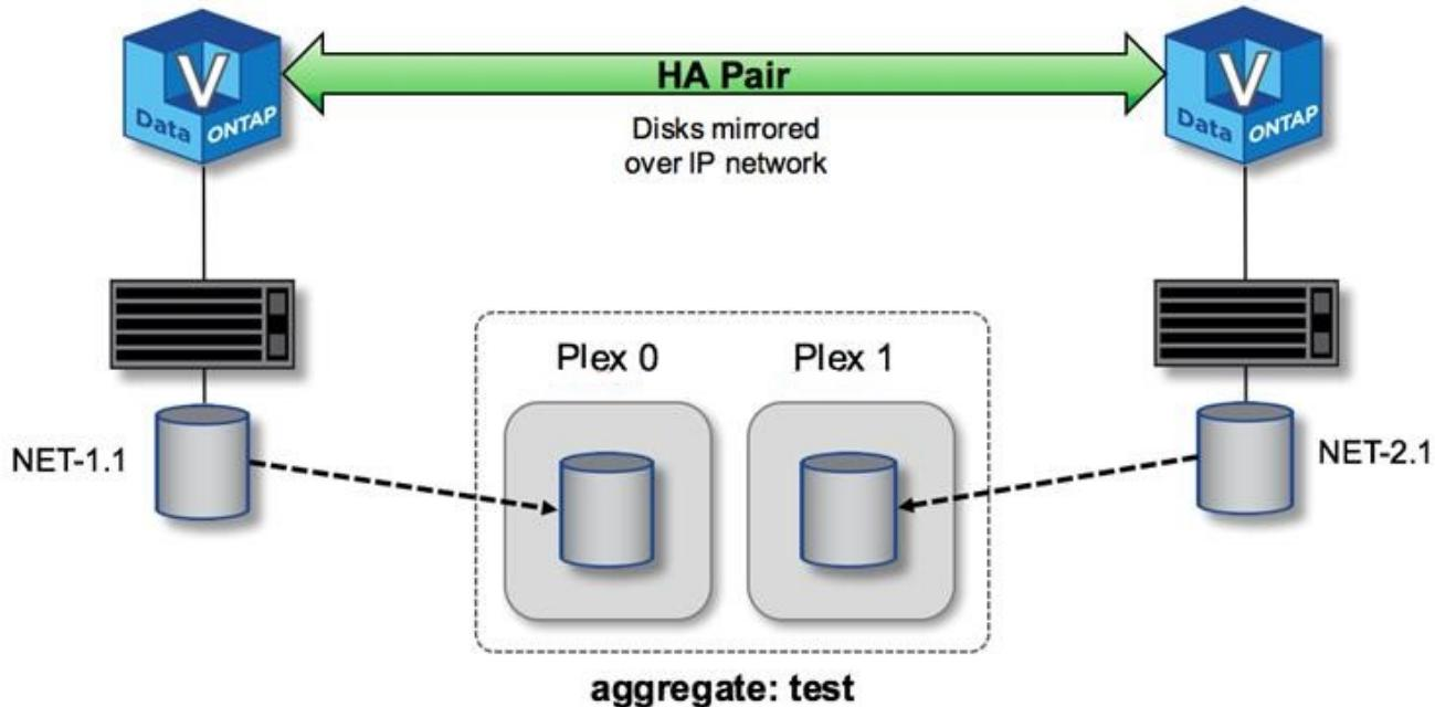
**i** 部署一個叢集時ONTAP Select、系統上的所有虛擬磁碟都會自動指派給正確的叢集、不需要使用者就磁碟指派採取額外步驟。如此可防止意外將磁碟指派給不正確的叢、並提供最佳的鏡射磁碟組態。
