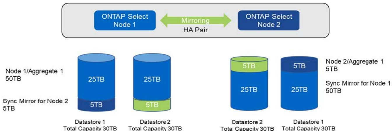
容量新增作業期間使用的VMDK大小上限為16TB。叢集建立作業期間所使用的VMDK大小上限仍為8TB。根據您的組態（單節點或多節點叢集）和新增的容量量、使用VMware部署可建立大小正確的VMDK。ONTAP不過、在叢集建立作業期間、每個VMDK的最大大小不得超過8TB、在儲存新增作業期間、大小不得超過16TB。
