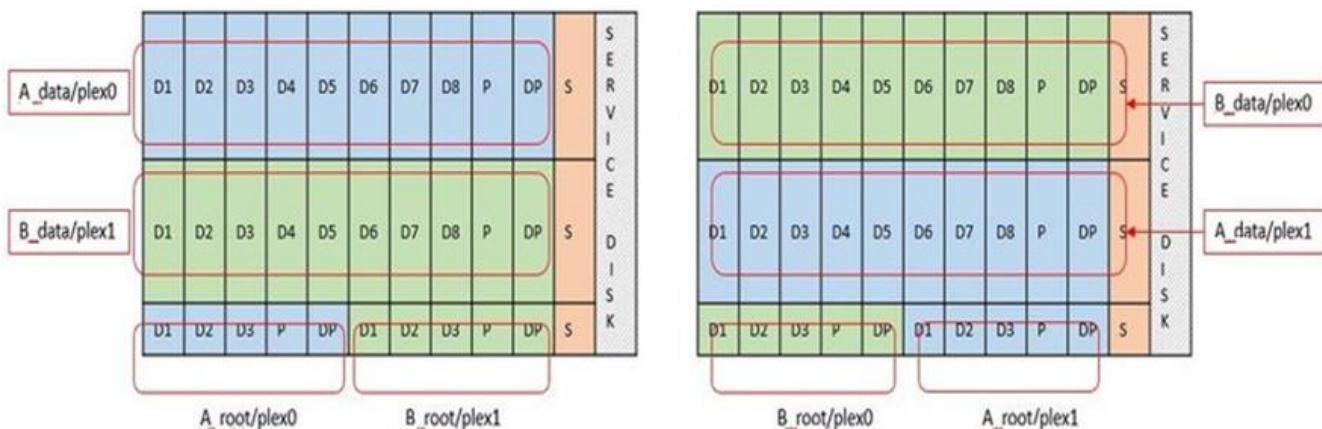
支援下列RAID類型的軟件RAID：RAID 4、RAID-DP及ONTAP RAID-TEC這些都是FAS由Same和AFF Same平台所使用的相同RAID架構。root資源配置ONTAP Select 僅支援RAID 4和RAID-DP。使用RAID-TEC 資料Aggregate時、整體保護是RAID-DP。NetApp HA使用無共享架構、將每個節點的組態複寫到另一個節點。ONTAP Select這表示每個節點都必須儲存其根分割區及其對等根分割區的複本。由於資料磁碟有單一根分割區、因此根據ONTAP Select 該節點是否屬於HA配對的一部分、資料磁碟的最小數量會有所不同。
