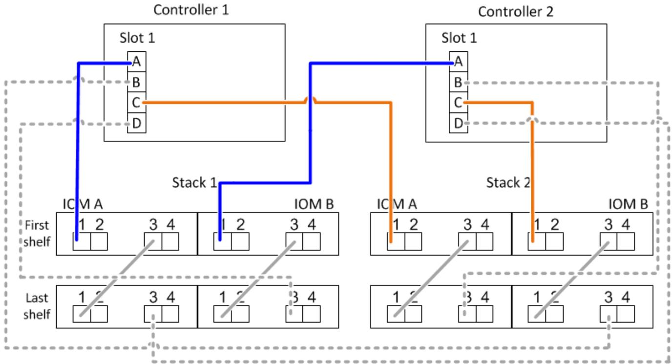
控制器B和D連接埠連線規則（適用於沒有內部儲存設備的平台）
