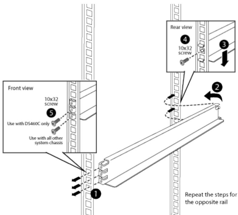
3. 如果您的設備安裝法蘭超出支撐軌道上的螺絲孔、請視需要在支撐軌道上方安裝鎖緊螺帽。
