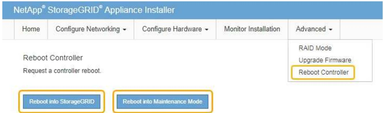
裝置重新開機和重新加入網格可能需要20分鐘的時間。若要確認重新開機已完成、且節點已重新加入網格、請返回Grid Manager。「節點」標籤應顯示正常狀態 ✓ 對於應用裝置節點、表示沒有任何警示處於作用中狀態、且節點已連線至網格。
