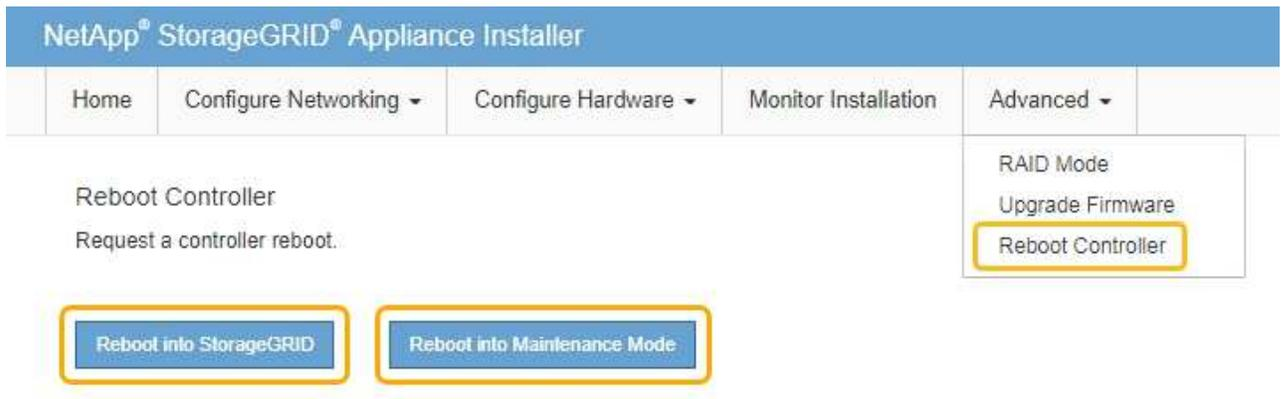
裝置重新開機和重新加入網格可能需要20分鐘的時間。若要確認重新開機已完成、且節點已重新加入網格、請返回Grid Manager。「節點」標籤應顯示正常狀態 ✓ 對於應用裝置節點、表示沒有任何警示處於作用中狀態、且節點已連線至網格。
