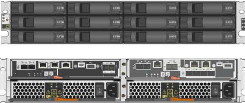
SG5712包含兩個控制器和兩個電源風扇迴管。
