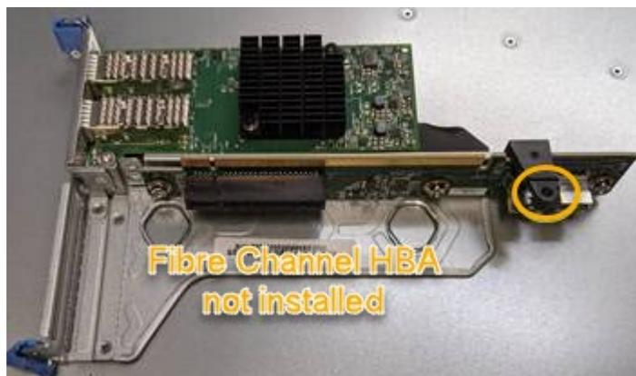
5. 將提升板部件放入機箱中，確保其與系統板上的連接器和導向銷對齊，然後插入提升板部件。
