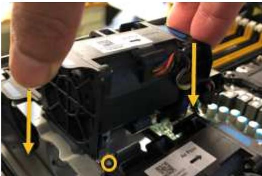
7. 將風扇的連接器穩固地按入電路板。
