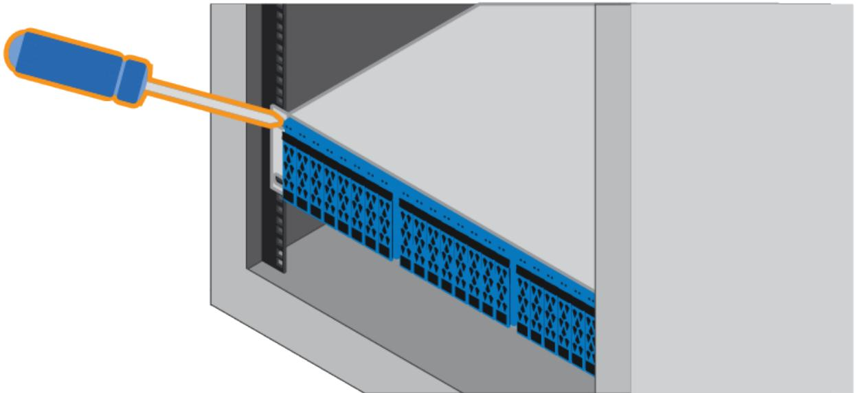
6. 將兩顆M5螺絲插入機箱的支架和軌道套件托架、將機箱固定在軌道的背面。
