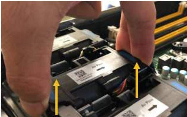
6. 將替換風扇滑入機箱的開放式插槽。
