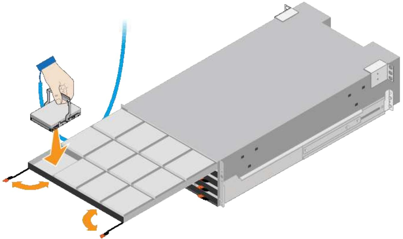
8. 將10個HDD磁碟機裝入頂端抽屜。
