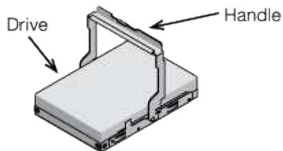
磁碟機已預先安裝在2U SG5612中、但出於安全起見、未安裝在4U SG5660中。
