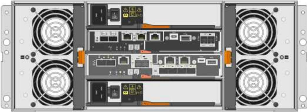
SG5760包含兩個控制器、兩個風扇迴管和兩個電源迴管。
