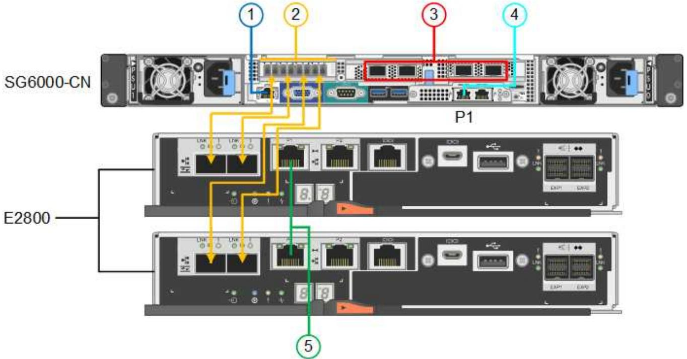
下圖顯示SGF6024應用裝置中的三個控制器、其中SG6000-CN-運算控制器位於頂端、而兩個EF570儲存控制器位於運算控制器下方。
