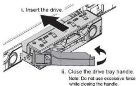
7. 將替換磁碟機插入插槽、然後關閉磁碟機握把。
