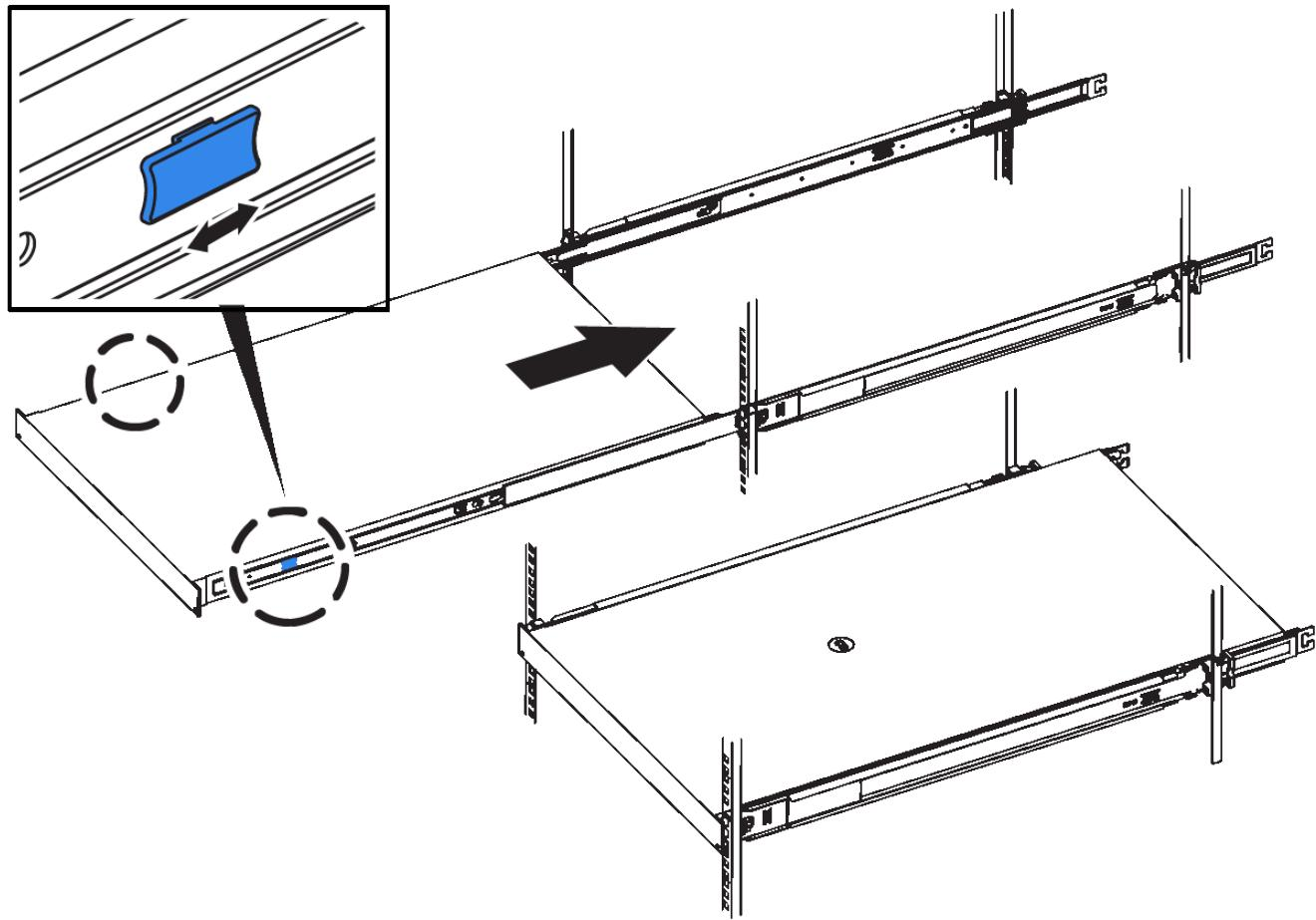
5. 鎖緊產品前面板上的緊固螺絲、將產品固定在機架中。
