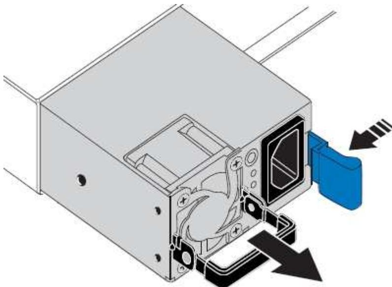
5. 在右側的藍色栓鎖中、將替換電源供應器滑入機箱。
