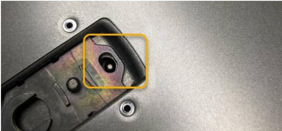
2. 向前或向下轉動機箱蓋栓鎖、直到其停止、並將機箱蓋完全裝入機箱。確認機箱蓋前緣沒有任何間隙。
