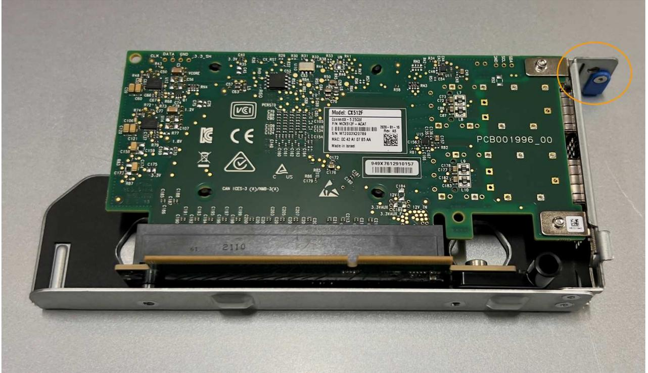
c. 找到單插槽提升板組件（圈選）上的定位孔、使其與主機板上的導引插針對齊、以確保提升板組件正確定位。
