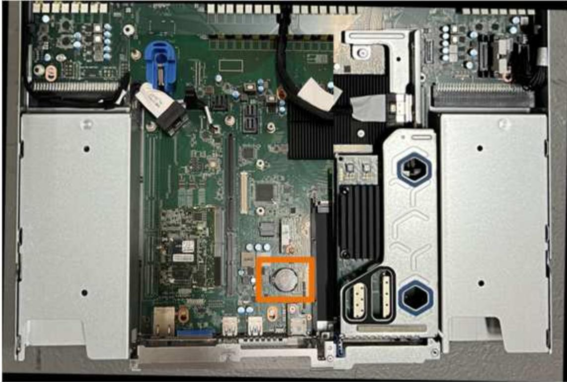
6. 使用手指或塑膠撬起工具、將固定夾（反白顯示）從電池上壓下、即可從插槽中彈出。
