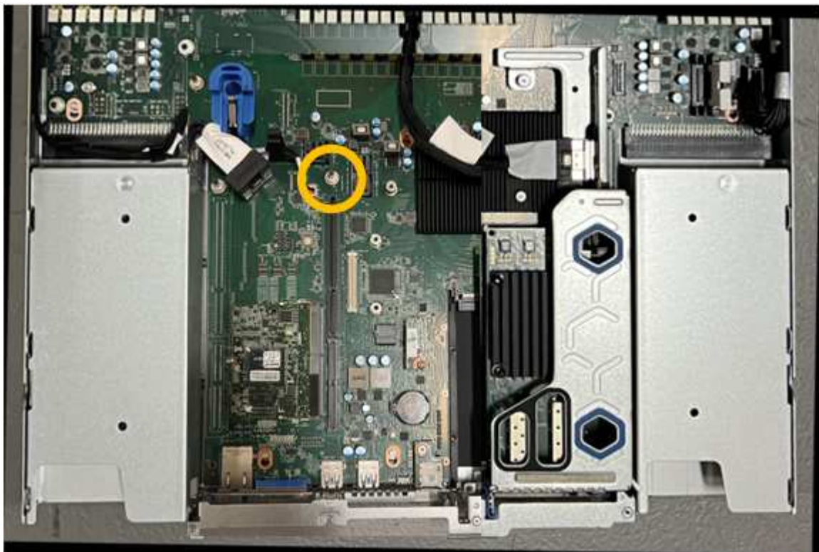
e. 將轉接器組件放入機箱中、確定其對齊主機板上的連接器和導引針。
